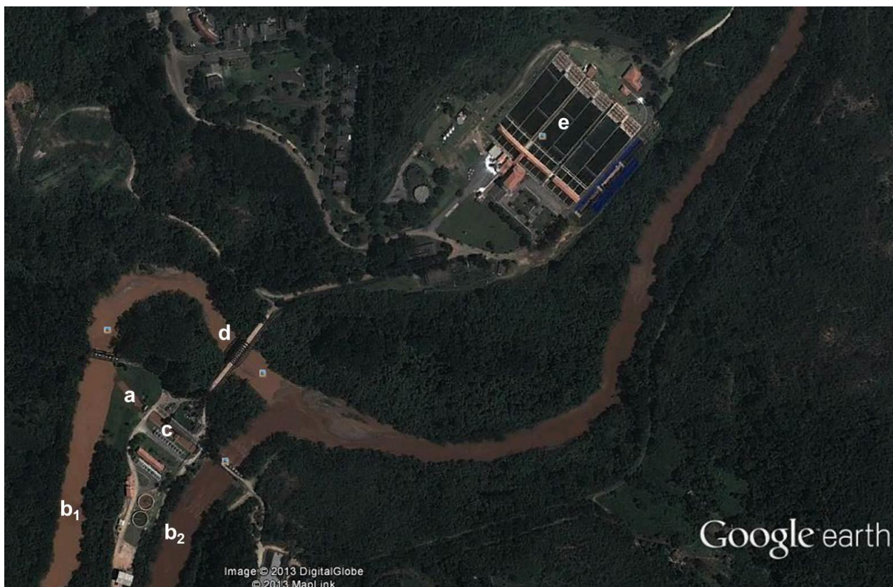
Figura 5.3 – Vista geral do Sistema de Tratamento de Água do Rio das Velhas: (a) captação; (b 1 ) alça de sedimentação esquerda; (b 2 ) alça de sedimentação direita; (c) elevatória de água bruta; (d) adutora de água bruta; (e) estação de tratamento de água.
