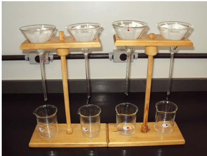
Figura 4.3 - Filtração da porção aquosa obtida na separação com o funil de separação
