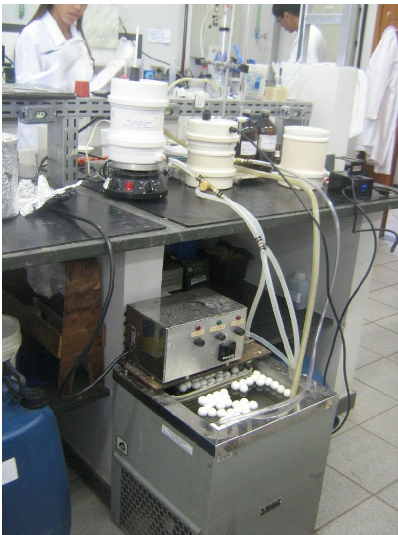
Figura 5.10 - Foto-reator e o respectivo sistema de refrigeração e circulação de água pelo foto-reator.
