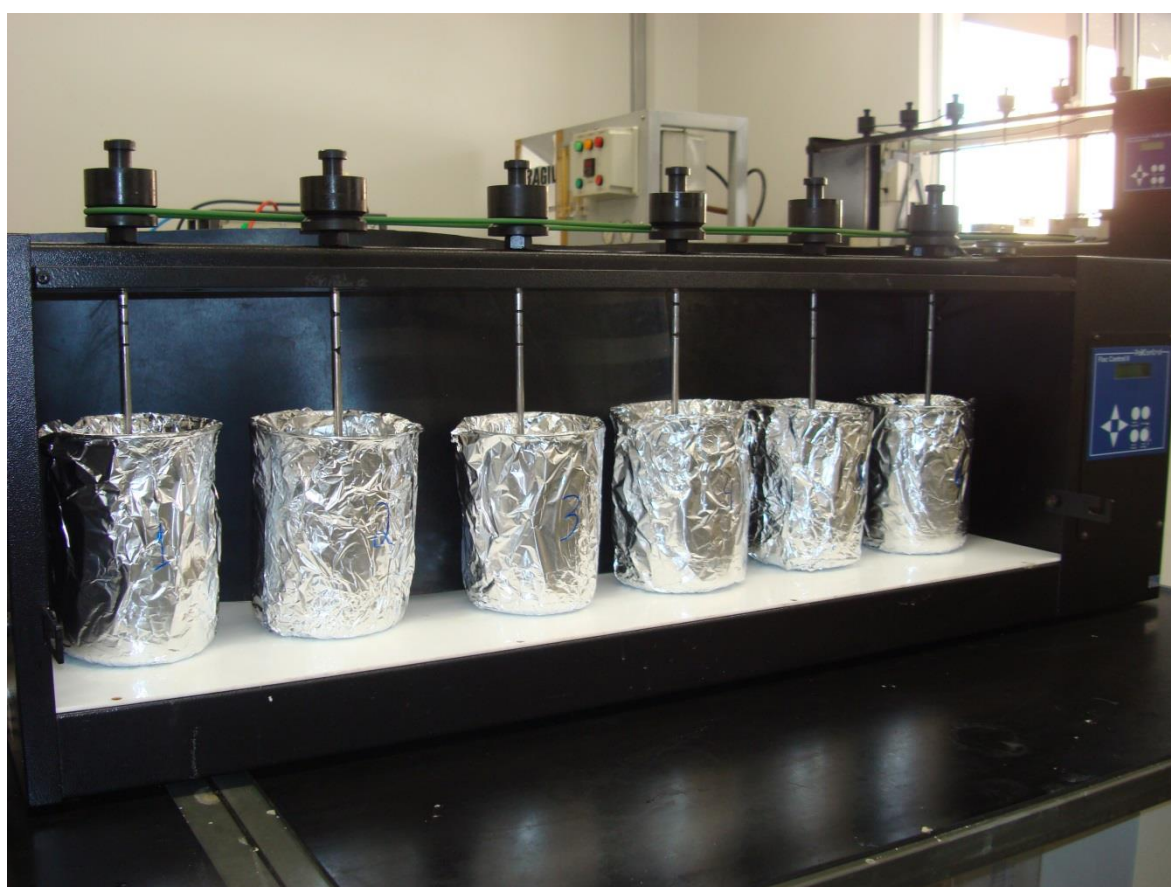
Figura 5.1 - Montagem no jar-test de 6 posições utilizado nos experimentos com Fenton.
