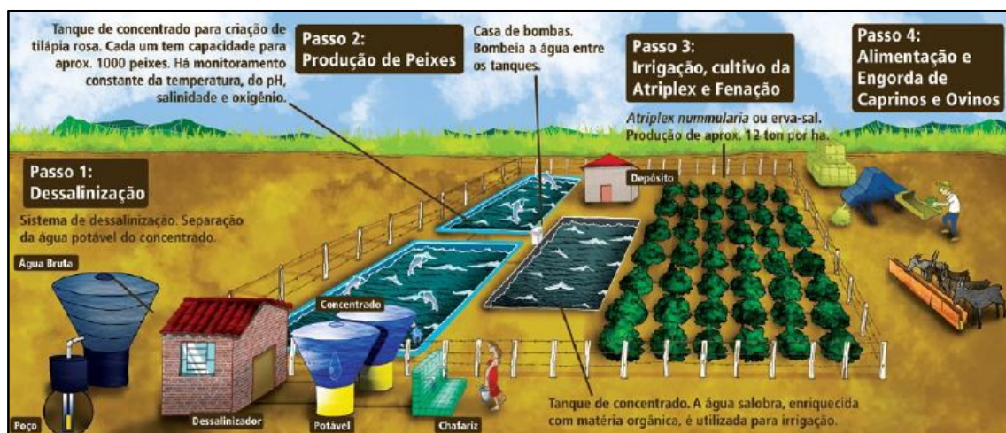
FIGURA 3.4 – Sistema integrado de dessalinização (PAD)
