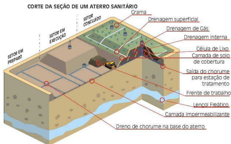
Figura 3.8 – Corte da seção de um aterro sanitário.
