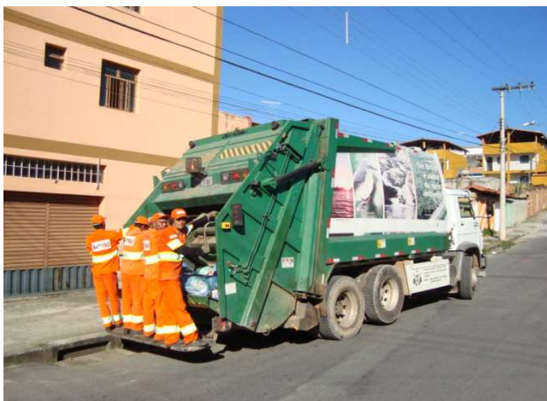
Figura 5.3 – Caminhão compactador e guarnição de coleta de resíduos úmidos.
