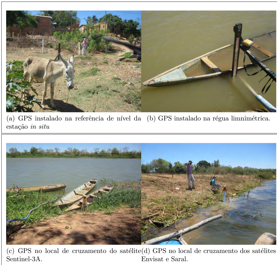
Figura 4.15: As fotografias mostram o GPS instalado em quatro pontos de medição, em todas as situações foi medido o nível do espelho d'água no dia do levantamento de campo, exceto no caso de (a), em que foi feita a medição das coordenadas da referência de nível global com o objetivo de nivelar a estação in situ .
