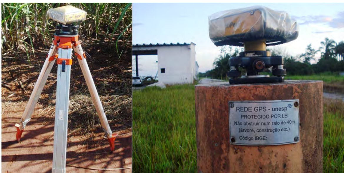
Figura 3.5: Aparelho de GPS da marca TopCon, modelo Hiper+ utilizado em campo. O aparelho está montado sobre um tripé, a esquerda, e também sobre o marco geodésico, a direita.
