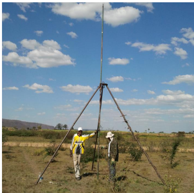
Figura 28 – Conjunto amostrador sendo testado em um dique marginal da Lagoa do Pontal
