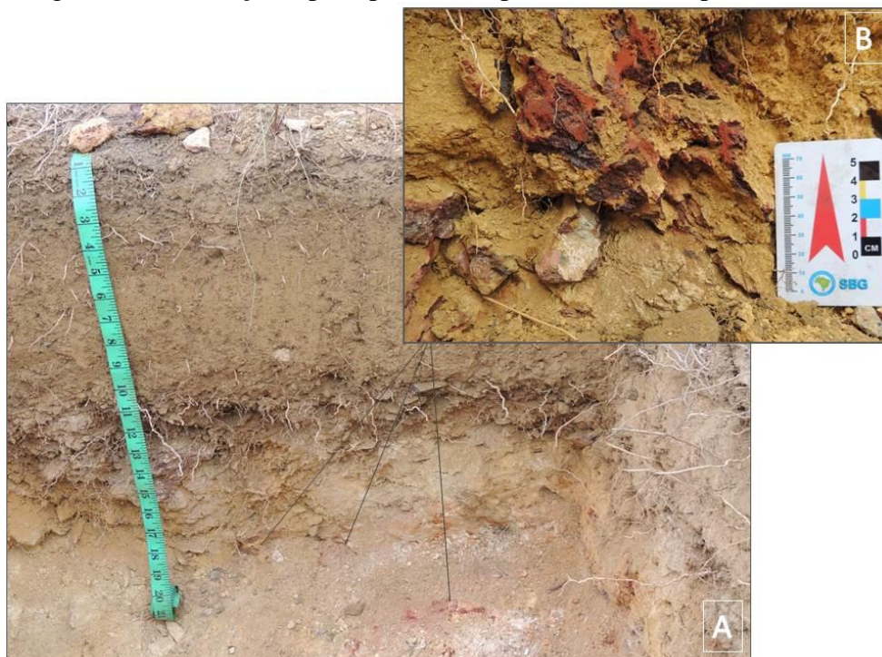
A) Perfil 4 – Cambissolo Háplico com plintita e petroplintita a partir de 24 cm de profundidade no Hz Cr. B) Detalhe da petroplintita. Fonte: Arquivo pessoal, 2017.
