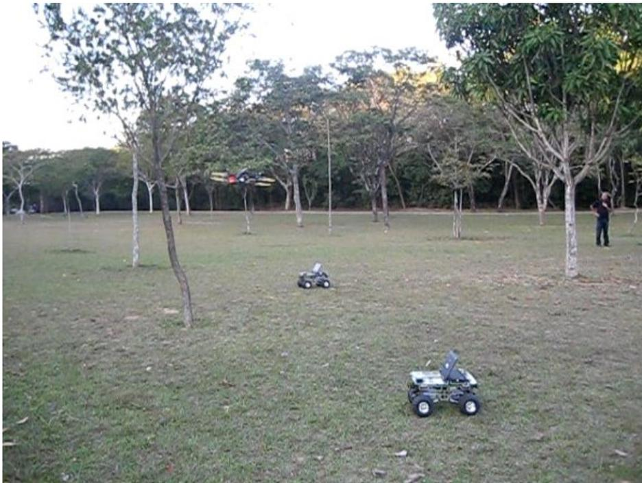
**Figura 6.7.** Plataforma de robôs heterogêneos do VeRLab: foram utilizados nos experimentos reais um quadrirotor *Hummingbird/Asctec* e dois robôs terrestres do tipo *Ackerman* construídos no VeRLab sobre a plataforma *Tamiya TXT-1 Monster Truck/Tamiya*.
