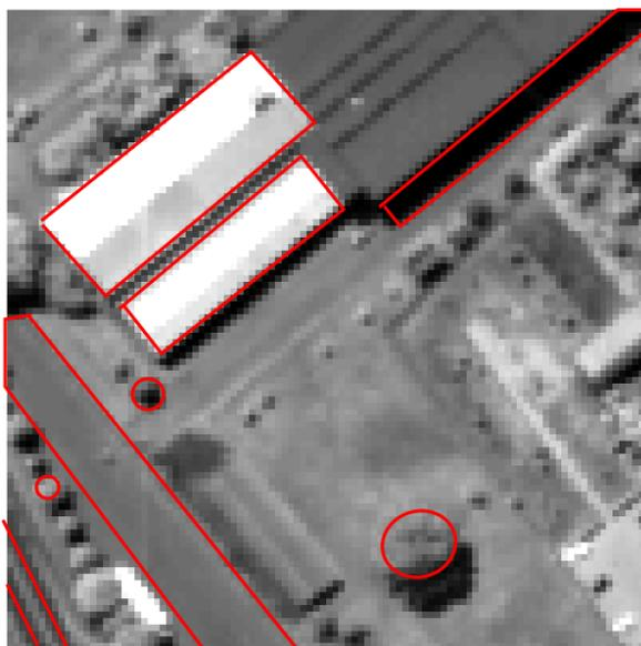
Figura 3.2: Exemplo de informação estrutural: grande, iluminado, estrutura retangular - pequeno, circular, estrutura texturizada - comprido, fino, estrutura escura... Retirado de Fauvel (2007).
