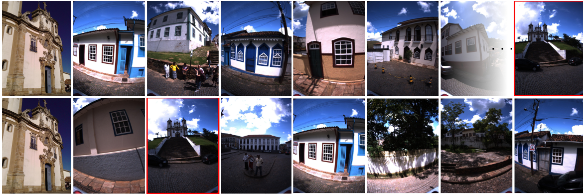
Figura 4.4: Melhoria no casamento de imagens através do uso da clusterização em subespaço: a linha superior mostra a imagem de busca (primeira imagem à esquerda) e sua similar (oitava imagem) que é a 209ª na lista de imagens similares da base de dados original. Após a aplicação do método proposto, nas oito imagens da linha inferior, a imagem de busca (primeira imagem à esquerda) é identificada como sendo a 3ª (terceira imagem da segunda linha) na lista de similaridade retornada pelo cluster usado.
