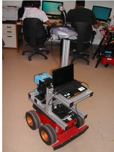
**Figura D.1.** Hardware Setup: Um robô Pioneer da Activmedia<sup>TM</sup> equipado com um *laser Sick LMS 200*, um controle e um netbook.
