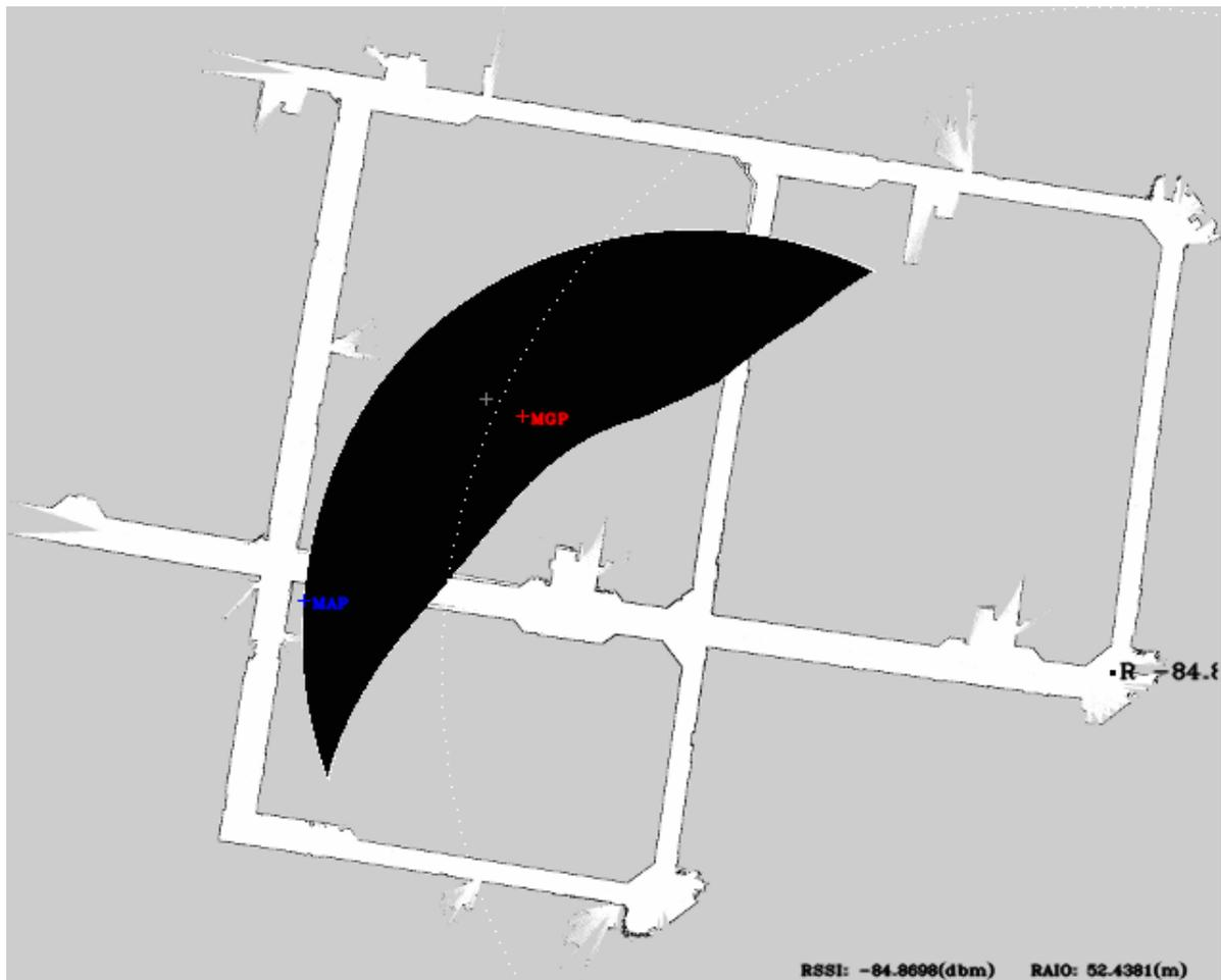
**Figura 4.17.** MAP  $\times$  MGP na inferência exata com distribuição uniforme. A cruz cinza é a posição verdadeira do nó sensor, o ponto preto com um "R" é a posição do robô e o número ao lado é o RSSI na localização do robô.
