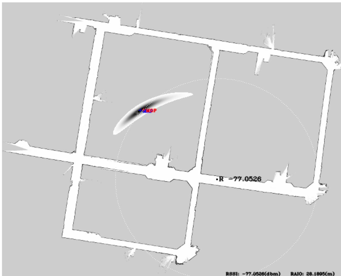
**Figura 4.16.** MAP  $\times$  MGP na inferência exata com distribuição normal. A cruz cinza é a posição verdadeira do nó sensor, a cruz vermelha é a estimativa por MGP e a azul por MAP, o ponto preto com um "R" é a posição do robô e o número ao lado é o RSSI na localização do robô.
