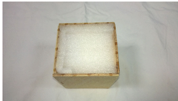
Figura 5.10. Espuma de polietileno expandido usada para preenchimento do cubo de madeira.
