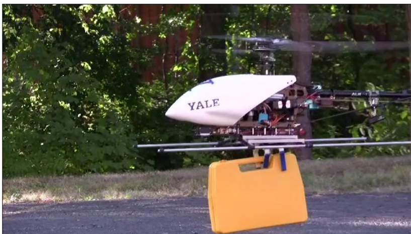
Figura 2.4: Transporte realizado por um quadrotor que utiliza uma garra para segurar o objeto demonstrado por Pounds et al. [2011].
