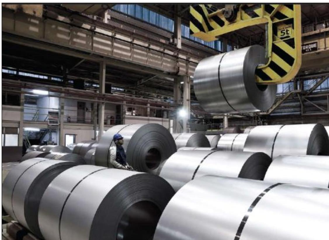
*Figura 2.3 – Bobina a frio - produto gerado na planta de laminação a frio. (Fonte: USIMINAS, 2015)*
