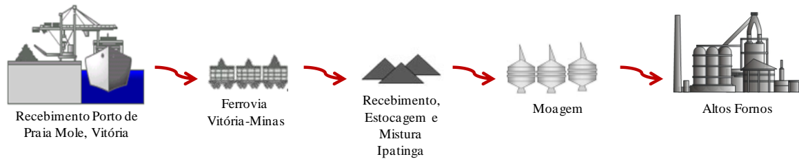
Figura 2: Fluxograma simplificado do preparo do PCI na Usina de Ipatinga.
