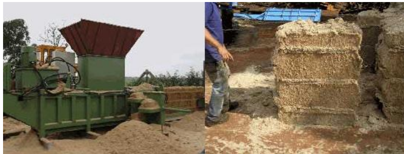
Figura 5 – Prensa hidráulica enfardadora da marca Ability. Fonte: Site da Ability (Acesso em 07/04/2016)
