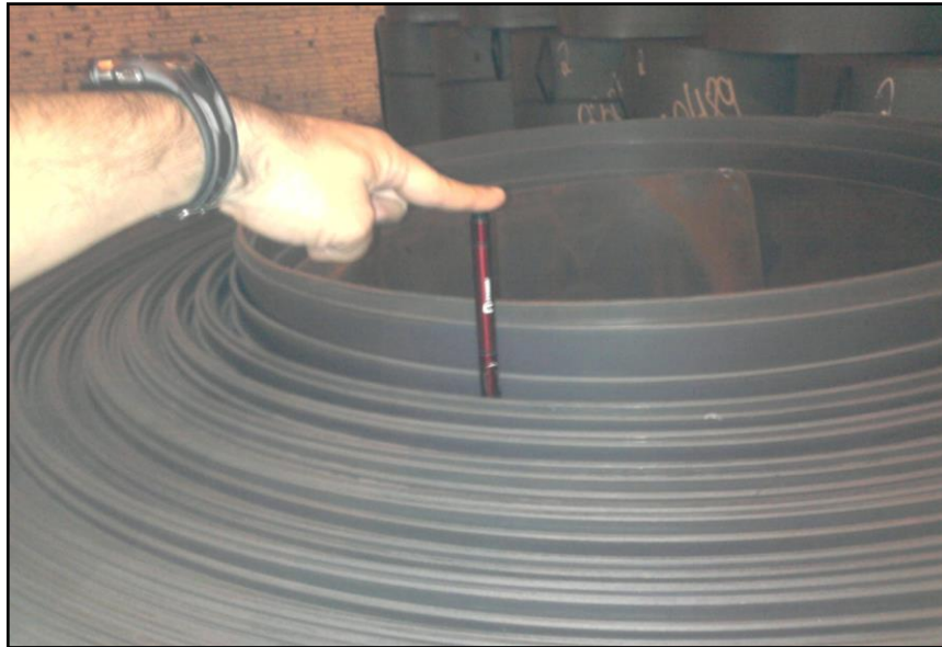
Figura 3 – Imagem que mostra bobina com problema no bobinamento
