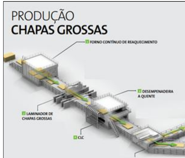
FIGURA 1 - Processo de Laminação de Chapas Grossas
