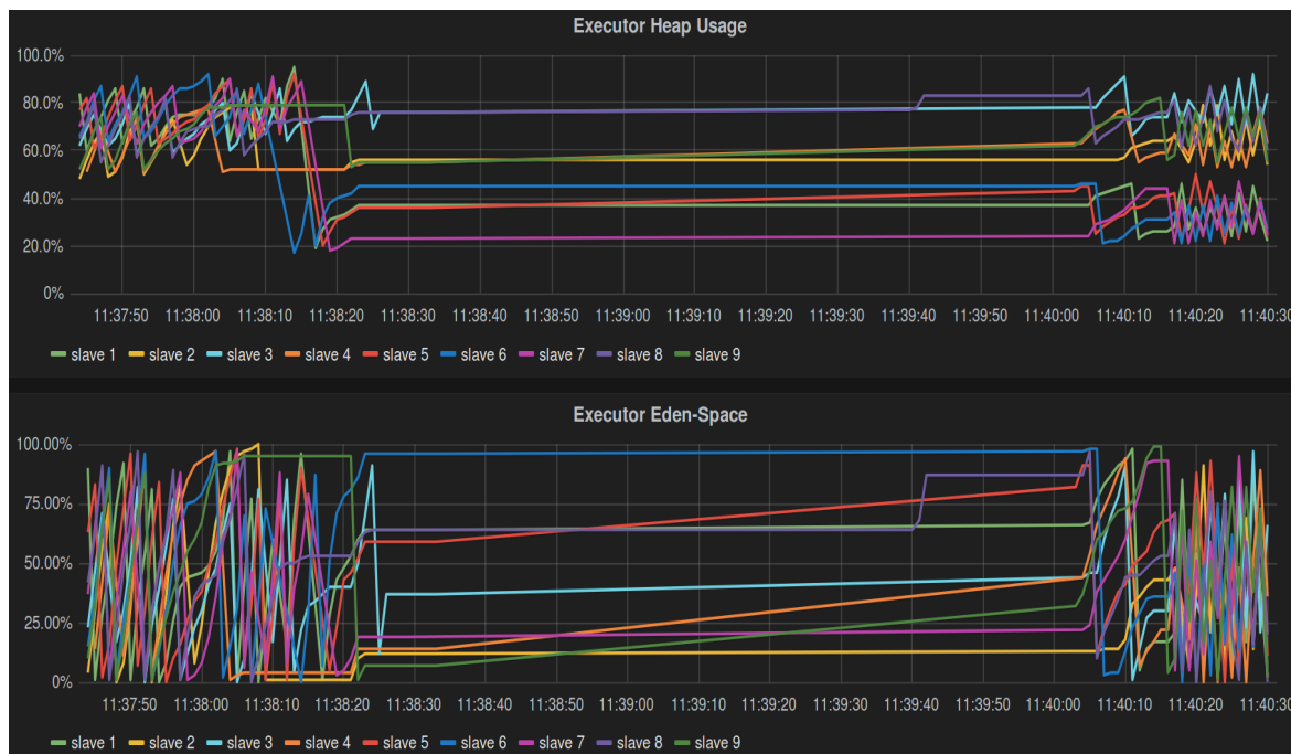
Figura 6.3. Dashboard de monitoração acompanhando a utilização de memória heap e de eden-space durante a execução de uma aplicação Spark no momento em que o problema foi detectado.
