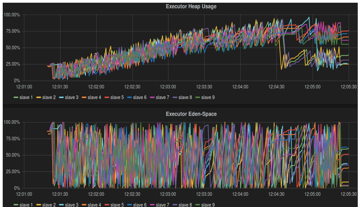
Figura 6.4. Dashboard de monitoração acompanhando a utilização de memória heap e de eden-space durante a execução de uma aplicação Spark no momento após a resolução do problema.
