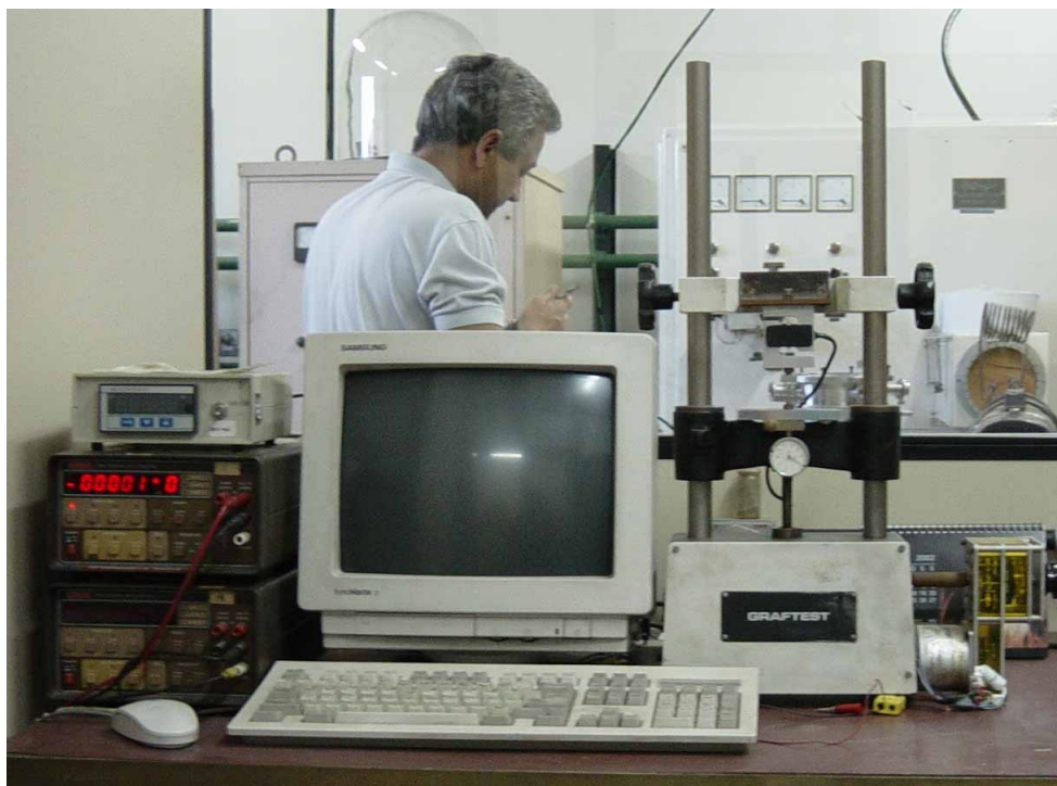
Figura 29 - Equipamento para ensaio mecânico do carbono pirolítico na configuração de flexão a quatro pontos.
