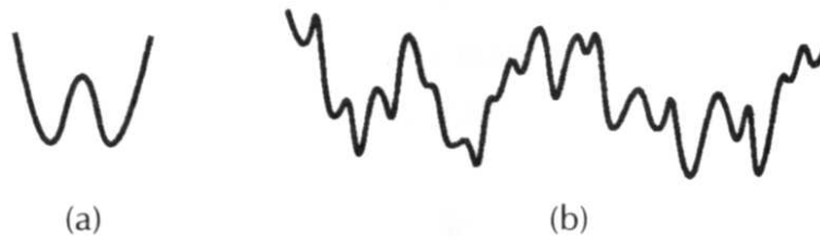
Figura 1.8: Ilustração de como seria um gráfico da energia em função dos estados para um sistema sem estados meta-estáveis (a) e para um sistema com estados meta-estáveis (b). Figura baseada em [8]
