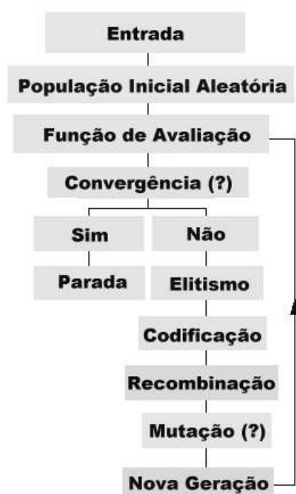
Figura 3.5: Sequência de eventos evolutivos seguidos pelo Algoritmo Genético implementado neste trabalho para a busca do mínimo global.
