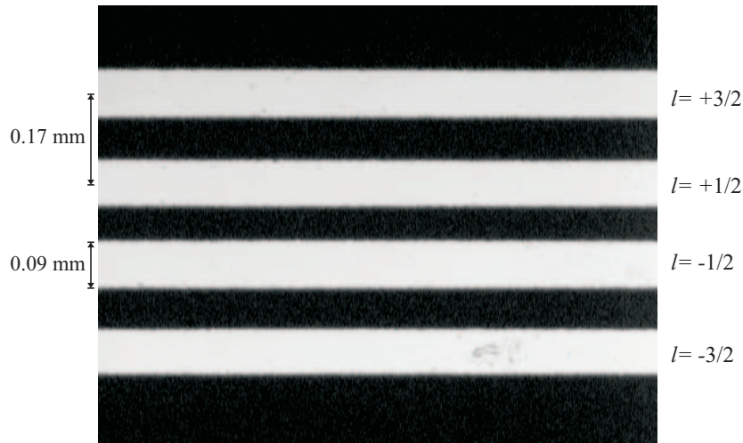
Figura 4.2: Imagem da fenda quádrupla, com suas dimensões d = 0.17 mm e 2a = 0.09 mm e também os seus rótulos l .
