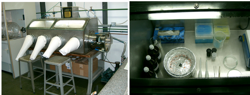
Figura 3.2 – Visão externa da câmara seca onde as amostras foram preparadas (esq.) e do interior da câmara (dir.), onde se destaca o spinner utilizado para fabricar os filmes.
