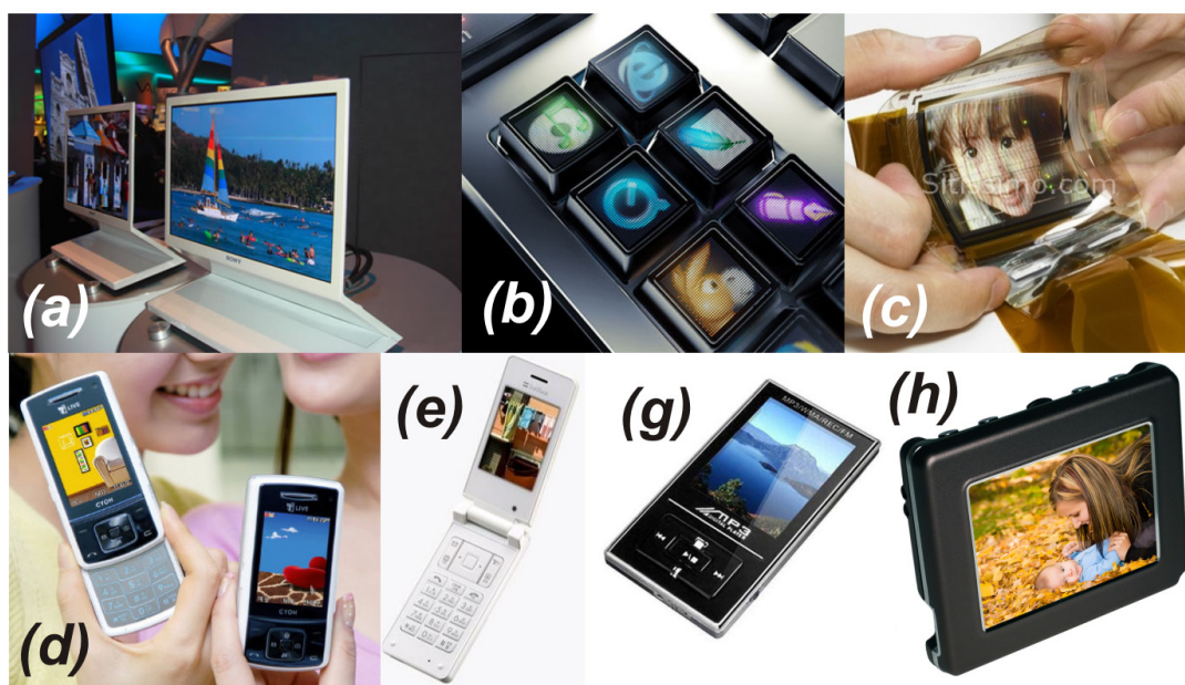
Figura 1.2 – Exemplos de produtos já comerciais utilizando OLEDs: como telas para televisores (a), para telefones celulares (d) e (e), para tocadores de mídia portáteis (g) e para álbuns fotográficos digitais de bolso (h). Outras aplicações mostradas são como telas flexíveis (c) e teclas coloridas de atalho em teclados (b).
