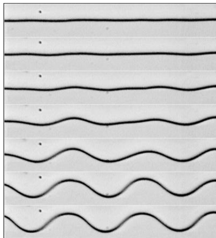
Figura 5: Evolução de um padrão celular em um experimento de solidificação direcional de um cristal líquido dopado com impurezas. (Fonte: [4], 1999, p. 6.)
