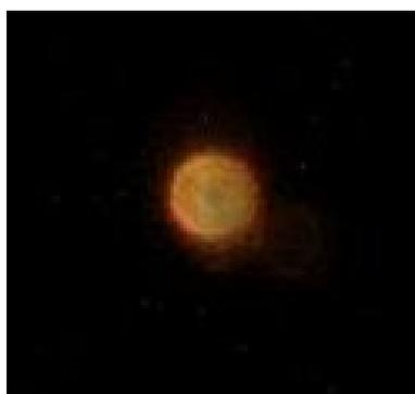
**Figura 4.8:** Luminescência gerada em uma estrutura FTO/PEDOT:PSS/MEH-PPV/ Al.
