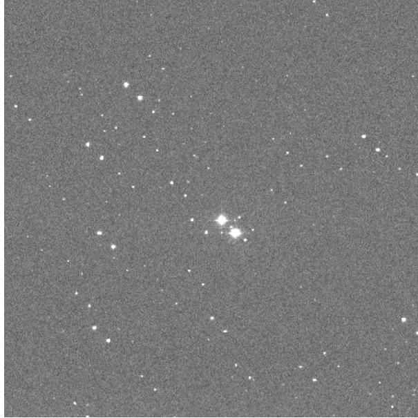
Figura 4.8: Exemplo de imagem coletada no LNA (telescópio IAG60cm) usando a gaveta polarimétrica e o CCD106, para a padrão polarizada HD160529. Note que os objetos aparecem duplicados devido a presença do prisma de Savart, que subdivide a luz incidente em dois feixes plano-polarizados ortogonalmente entre si.
