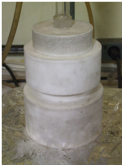
Figura 2.1: Recipiente com condensador de refluxo. Figura 2.2: Recipiente de teflon onde são sintetizados os TNTs.
