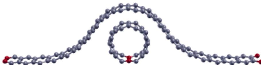
**Figura 5.4** Supercélula relaxada para a camada de grafeno depositada no nanotubo de carbono. Os átomos destacados em vermelho são mantidos fixos nos cálculos.
