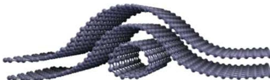
**Figura 5.2** Dupla camada de grafeno depositada sobre uma rede de nanotubos de carbono.
