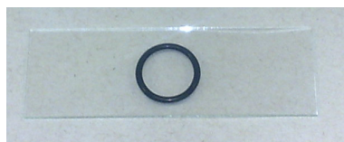
Figura 4.4: Porta amostras: consiste de um O-ring de diâmetro de cerca 1,5 \text{ cm} colado com parafina, em uma lamínula de vidro (Corning) de 0,17 \text{ mm} de espessura.
