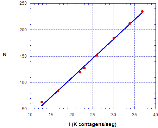
Figura 4.5: Nível de cinza N em função da intensidade luminosa I medida pelo contador de fótons. Para este ajuste particular da câmera, N = -36,7 + 7,3I . O parâmetro importante para calibração do contraste é B = -36,7 , que corresponde ao nível de cinza para o valor da intensidade luminosa igual a zero, da extrapolação linear.
