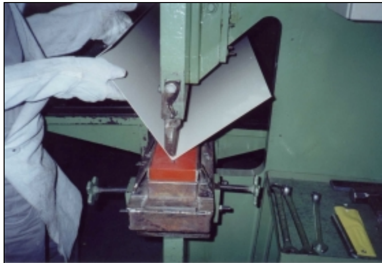
Figura 1.2 - Produção dos perfis pelo processo de dobragem.
