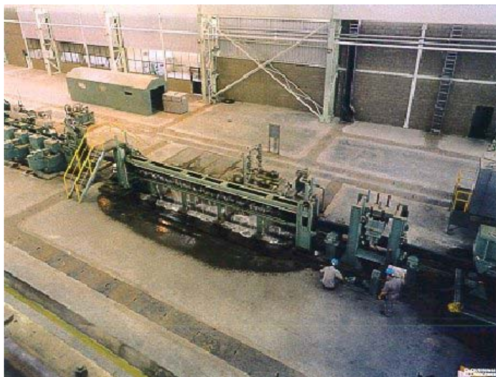
FIGURA 2.11 – Processo de resfriamento seguido do alinhamento.
