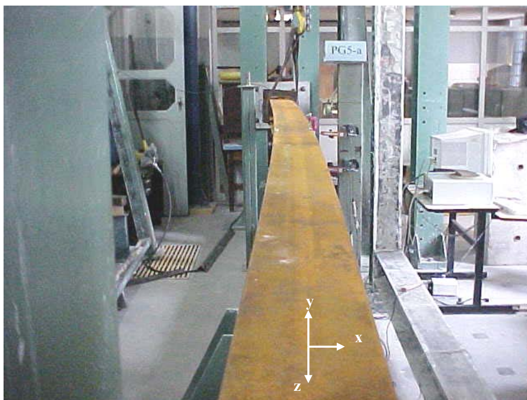
FIGURA 5.4 – Deformada do perfil PG5-a, após ensaio.
