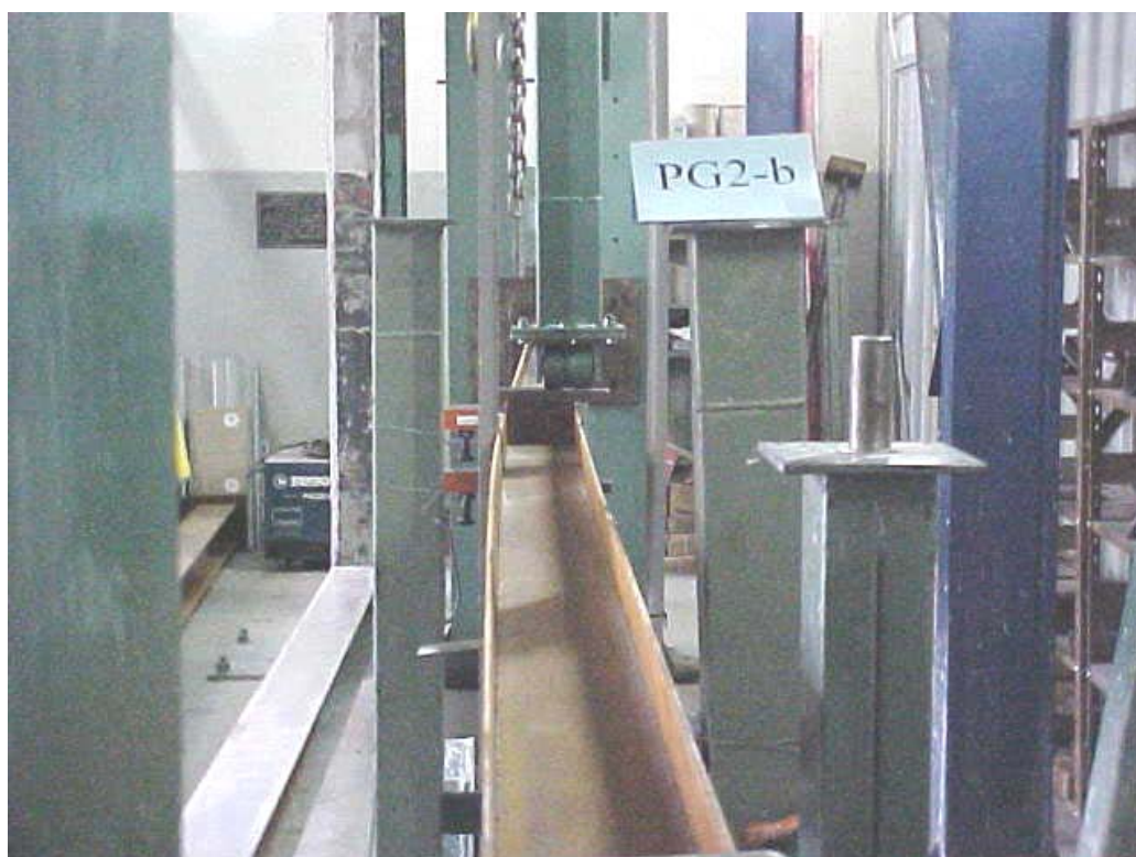
FIGURA 5.6 – Deformada do perfil PG2-b após ensaio.
