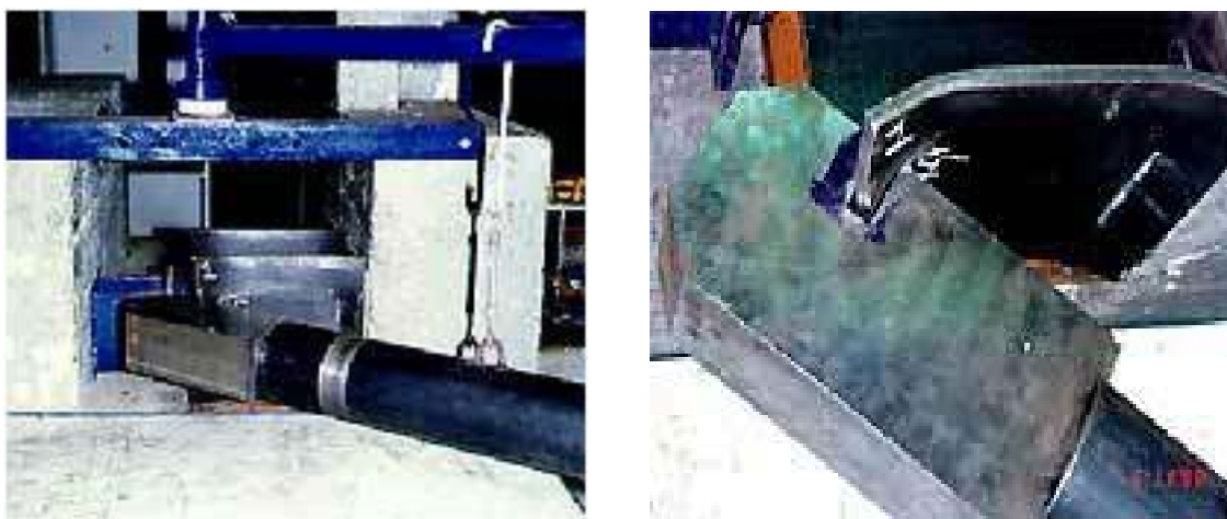
FIGURA 2.14 – Fotos do teste de arrancamento feito no IPT (1999).
