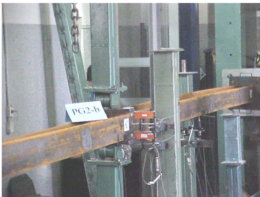
FIGURA 5.7 – Deformada do perfil PG2-b após ensaio.
