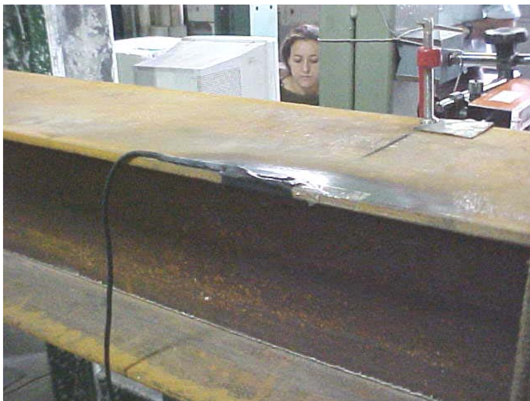
FIGURA 4.27 – EER para medir as deformações específicas longitudinais.
