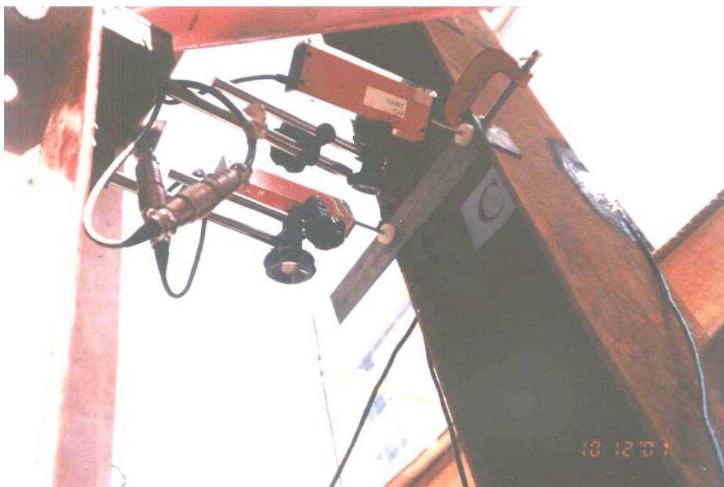
FIGURA 4.8 – Instrumentação da seção central do perfil de 3538 mm.
