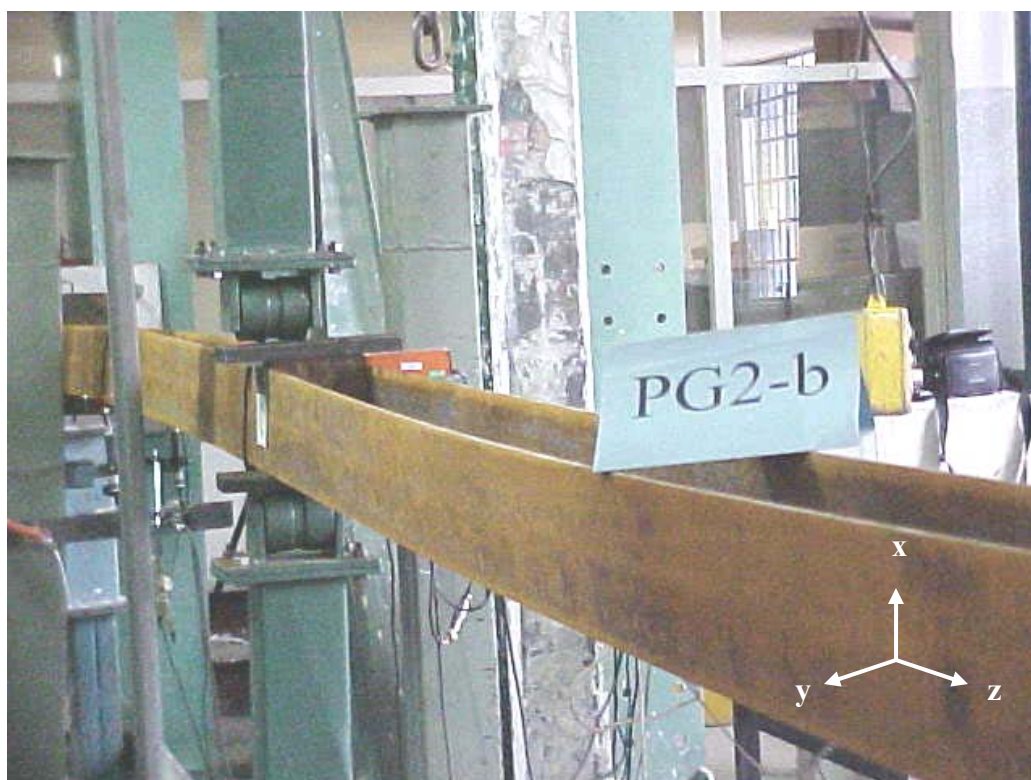
FIGURA 5.5 – Deformada do perfil PG2-b após ensaio.
