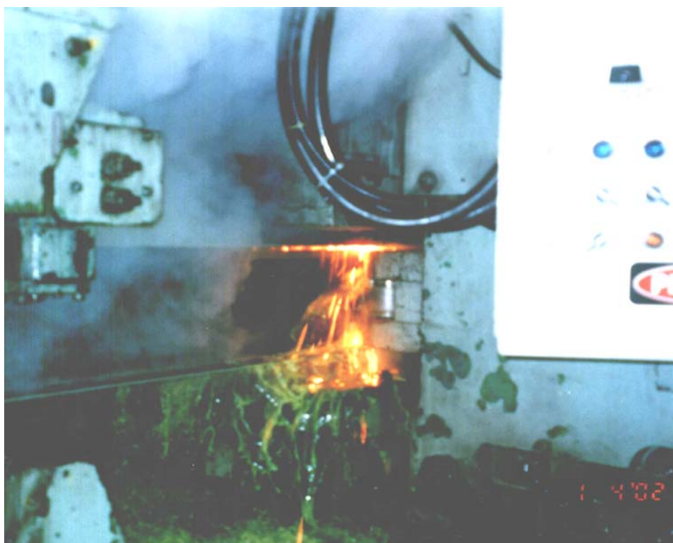
FIGURA 2.9 – Eletrossoldagem por alta frequência (Eletrofusão).
