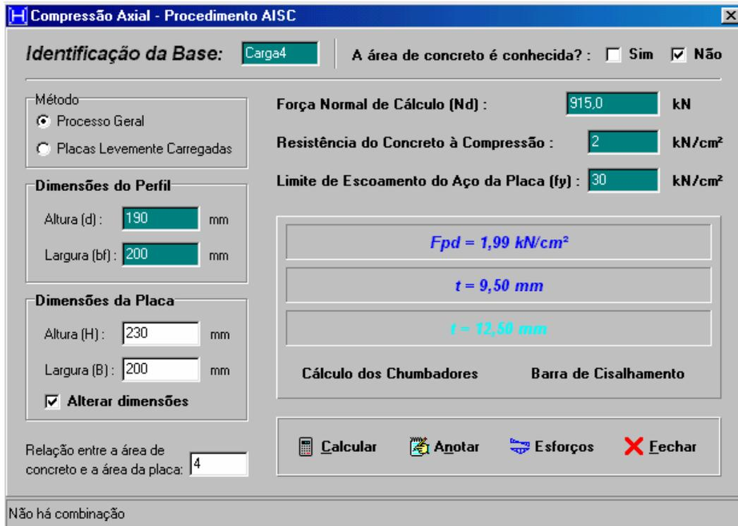
FIGURA 2.20 – Janela compressão axial / procedimento AISC (DeWolf & Richer 1990).
