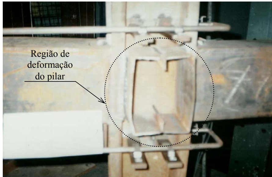
FOTO 3.19 - Modelo 03B após o ensaio
