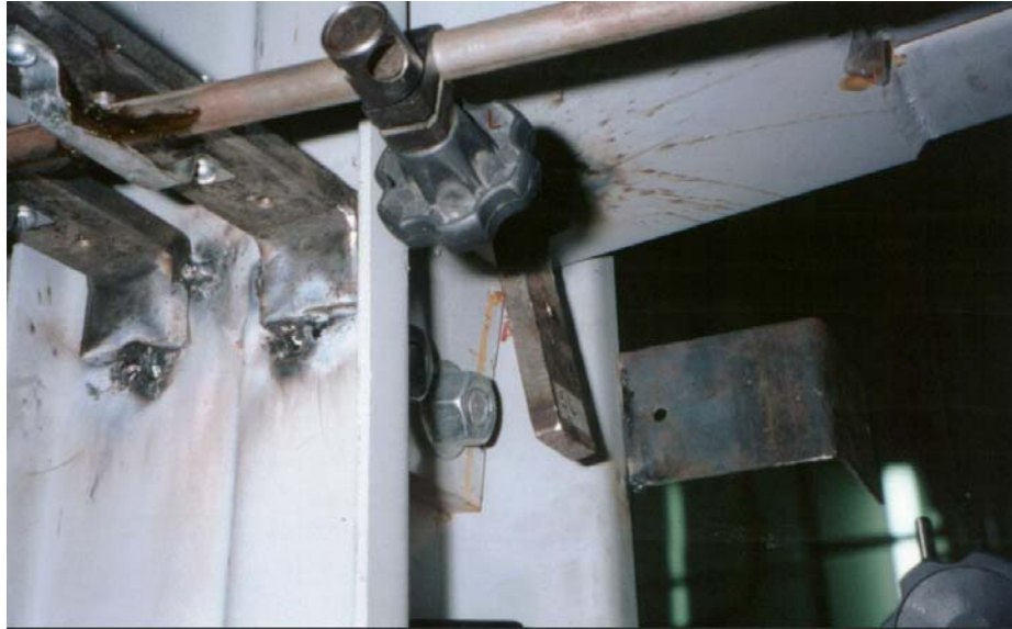
FOTO 3.13 – Modelo 01A : formação de charneira plástica
