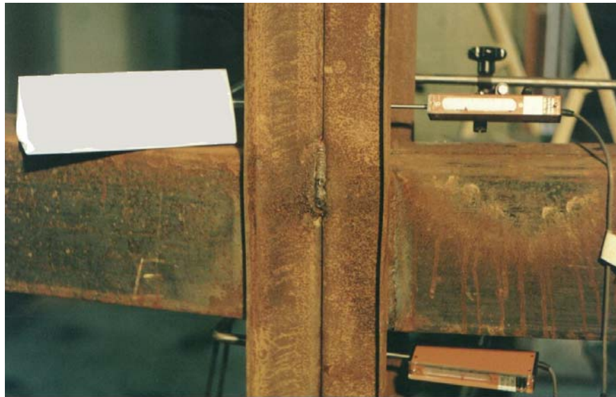
FOTO 3.20 - Modelo 04A após o ensaio (flambagem dos enrijecedores de borda)
