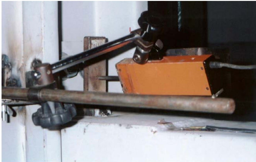
FOTO 3.8 – Transdutor de deslocamento (DT 50 ), gancho e suportes de medida
