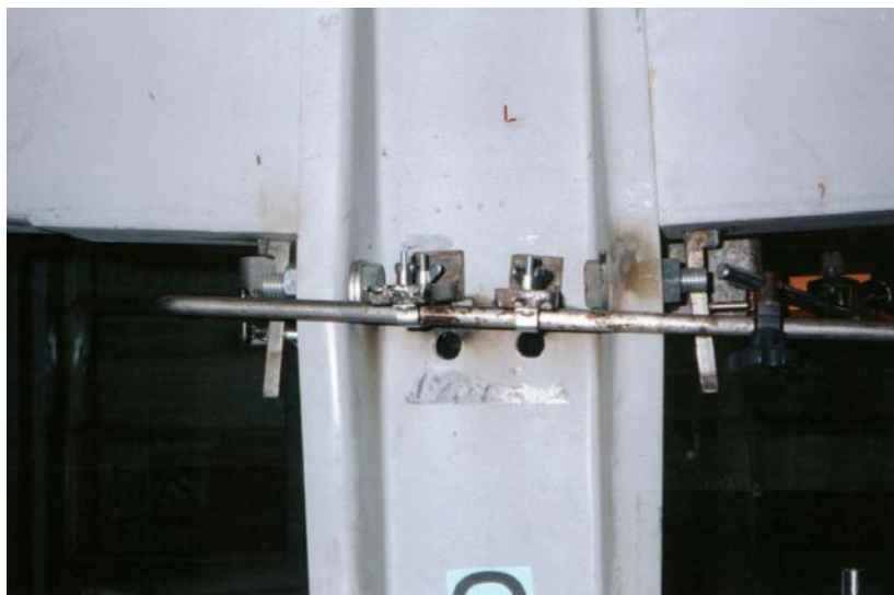
FOTO 3.17 – Modelo 02B : detalhe da plastificação
