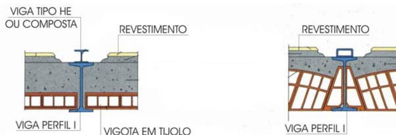
FIGURA 5.26 – Elementos soldados na face superior da viga.
