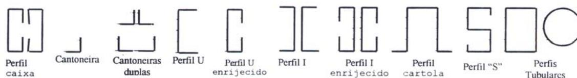
FIGURA 2.10 – Perfis estruturais formados a frio quando comprimidos.
