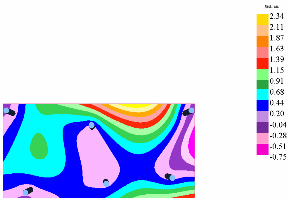
FIGURA 8.162 – Flechas em Serviço (Máximo = 2.34 mm, e a Longo Prazo = 7.02 mm)
