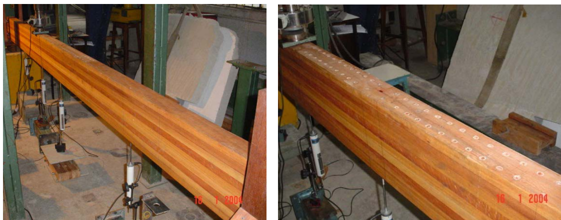
FIGURA 79 – Ensaio de flexão estática nas vigas de MLC com os furos
