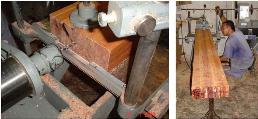
FIGURA 44 – Furo guia para a execução das ranhuras
