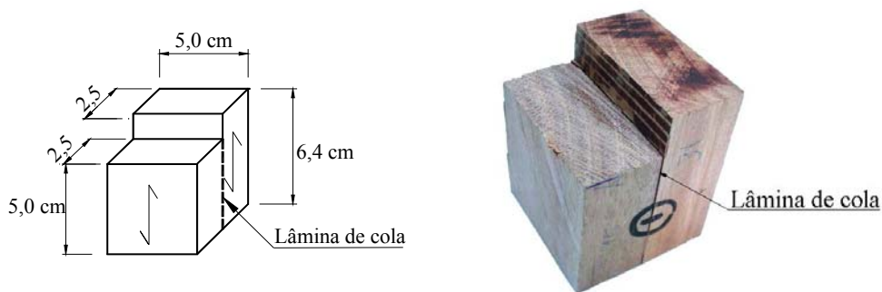
FIGURA 64 – Corpos-de-prova para ensaio de cisalhamento na lâmina de cola
