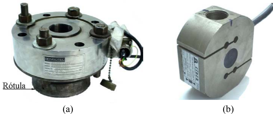
FIGURA 69 – Células de carga (a) Célula de carga de 100 kN (b) Célula de carga de 50 kN
