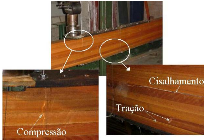
FIGURA 117 – Ruptura na viga com 60 parafusos auto-atarraxantes
