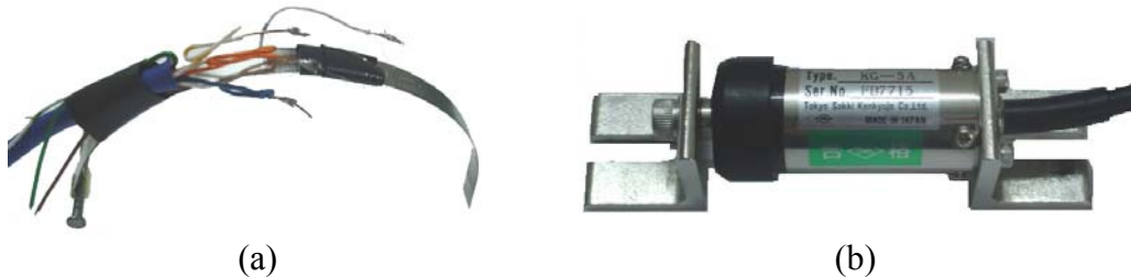
FIGURA 71 – Outros transdutores de deslocamento (a) Fabricado no LAEES (b) KJ-5A
