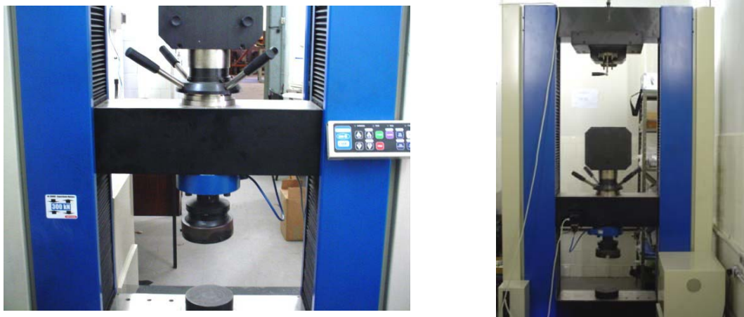
FIGURA 58 – Máquina universal com capacidade de 300 kN
