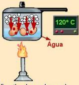
Como a panela de pressão é hermeticamente fechada à medida que a água entra em **ebulição** (100° C), o vapor formado **não tem por onde escapar**.
