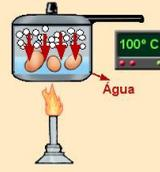
Como a panela de pressão é hermeticamente fechada à medida que a água entra em **ebulição** (100° C), o vapor formado **não tem por onde escapar**.
