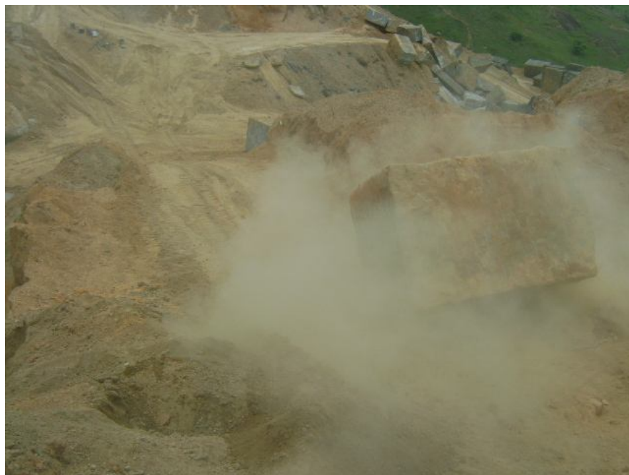
Figura 26 Rolamento final do bloco para alcançar o local onde está localizado o pau-de-carga para o carregamento da carreta que levará o bloco ao seu destino final. Nesse momento, o operador tem o cuidado de descer da retro-escavadeira e olhar todo o local para se certificar que no local não tem ninguém ou qualquer veículo que possa ser atingido pelo bloco que desce rolando de maneira desordenada.
