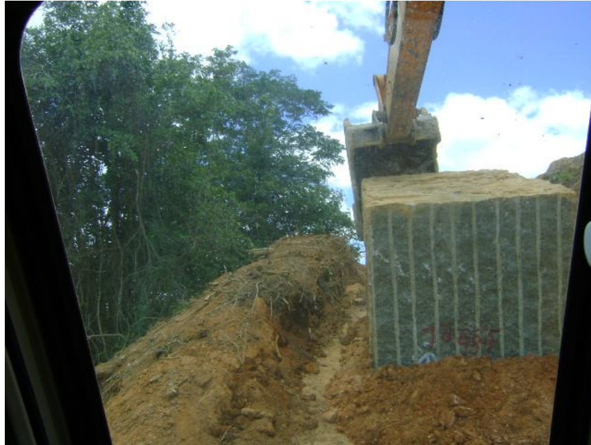
Figura 25 Descida de bloco durante a movimentação do mesmo através da pedreira. Nessa imagem, a retro-escavadeira encontra-se atrás do bloco e está rolando o mesmo e sua direção, ou seja, para cima de si mesmo. Essa é a situação de maior perigo enfrentada pelo operador de máquinas, já que qualquer problema envolvendo este movimento pode acarretar no choque entre o bloco e a máquina;
