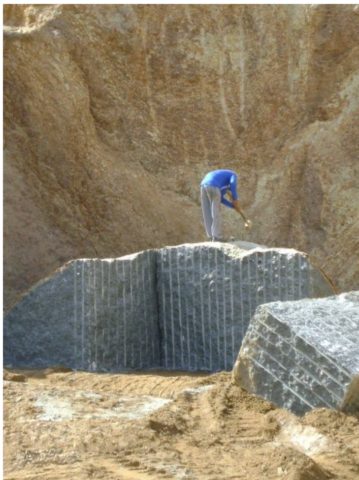
Figura 138 Ajudante batendo a marreta na cunha de pressão para a divisão de blocos. Trabalho que além do dispêndio de força, é executado diariamente em posições que exigem a encurvação do corpo.
