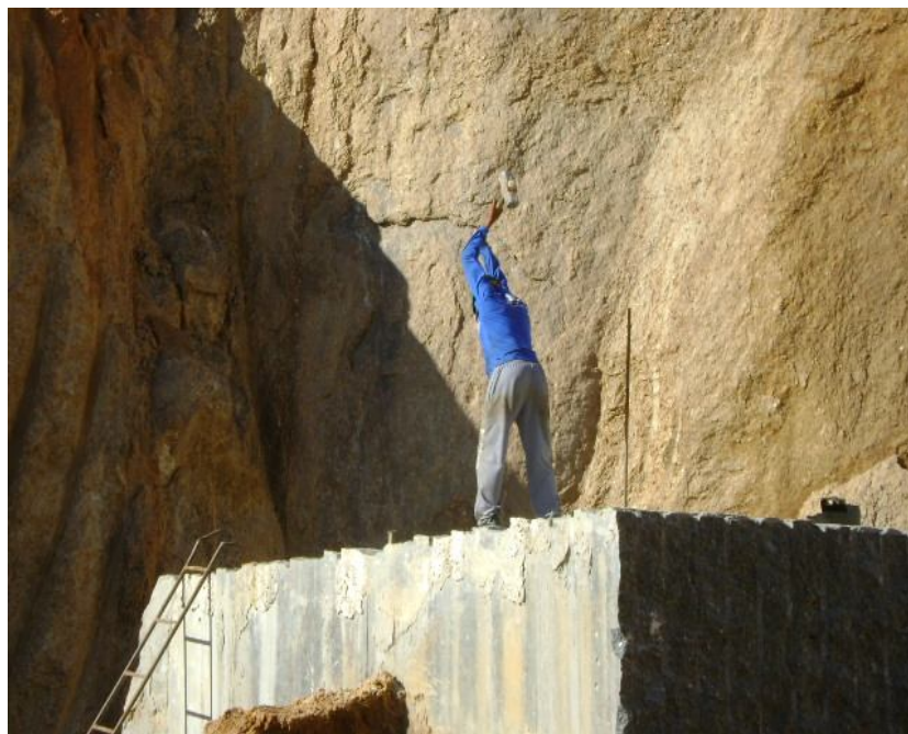
Figura 20 Utilização da cunha no processo de separação de blocos;
