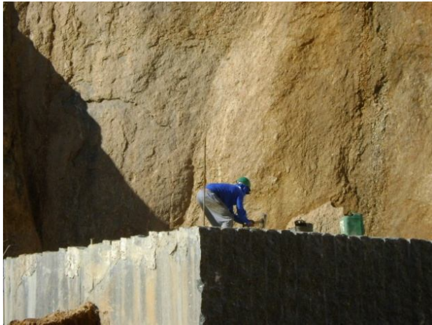
Figura 22 Utilização da cunha no processo de separação de blocos.
