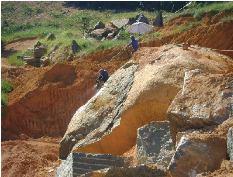
Figura 127 Na imagem se visualiza um marteleteiro perfurando, enquanto o outro prepara seu equipamento.
