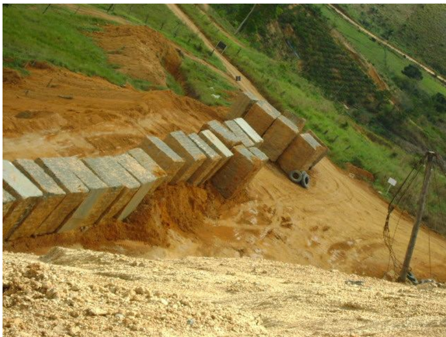
Figura 30 Blocos armazenados no pátio já próximo ao pau-de-carga aguardando para serem escoados;
