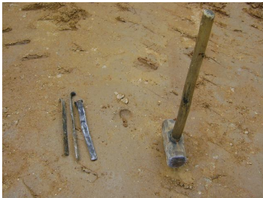
Figura 19 Cunhas metálicas e marreta, instrumentos utilizados manualmente na separação dos blocos da prancha;
