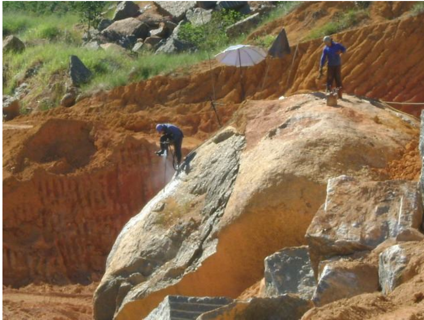
Figura 134 Na imagem pode-se visualizar o marleteiro trabalhando com o corpo completamente curvado realizando grande dispêndio de força com os braços e pernas para realizar a perfuração.
