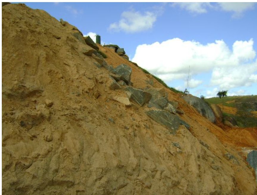
Figura 102 Rejeitos soltos em barranco, próximo ao fundo da área de extração. (Foto tirada em julho de 2010;)
