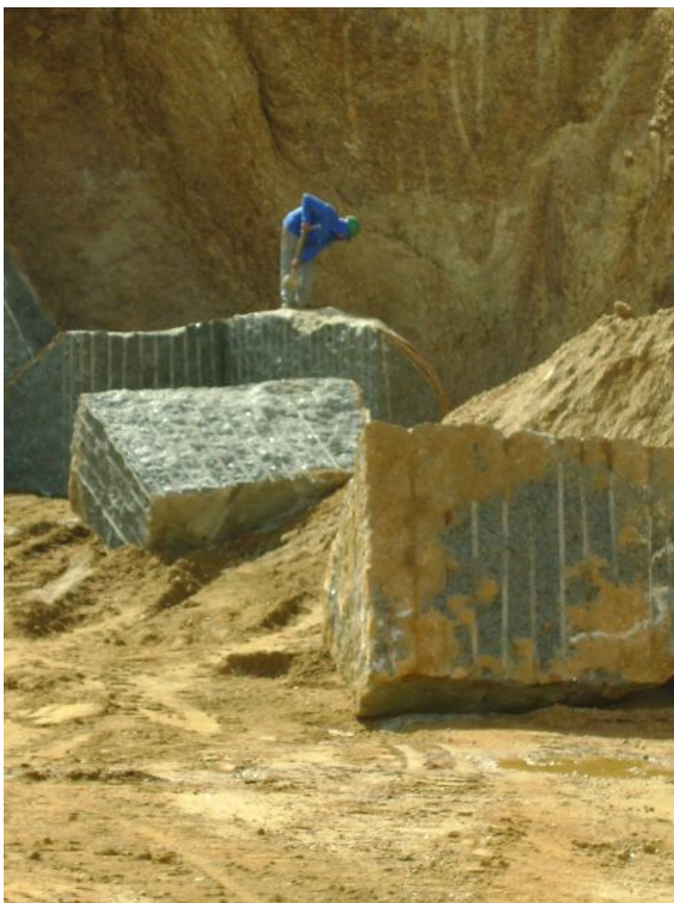
Figura 135 Ajudante no serviço de divisão dos bloco pelo processo de cunha de pressão. Verifica-se que nesta tarefa o trabalhador passa parte do dia em serviço monótono e constantemente em posições encurvadas ou torcidas.
