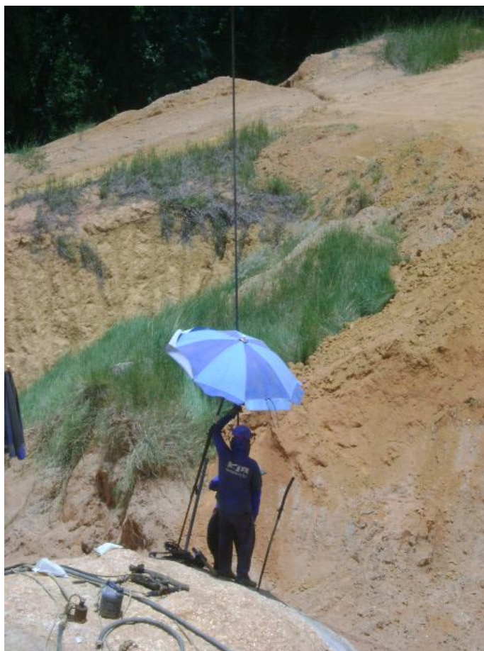
Figura 137 Trabalhadores colocando a broca de perfuração de rochas na mina. Eles realizam esta tarefa em dois devido ao peso da broca ser grande (entre 30 e 80 Kg). Esta tarefa é realiza entre dois trabalhadores para se colocar e retirar as brocas.
