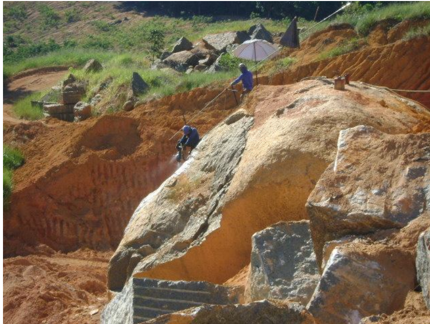
Figura 136 Trabalhador carregando a broca de perfuração das rochas que pesam em media entre 30 e 80 Kg.
