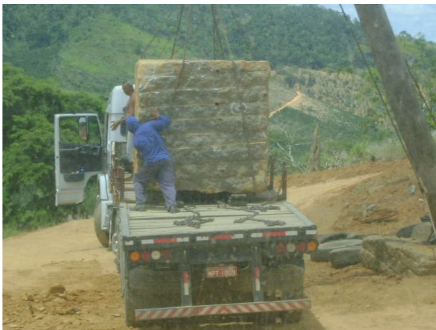
Figura 48 No final da descida do bloco, o mineiro e o caminhoneiro ajustam, manualmente, o bloco na melhor
