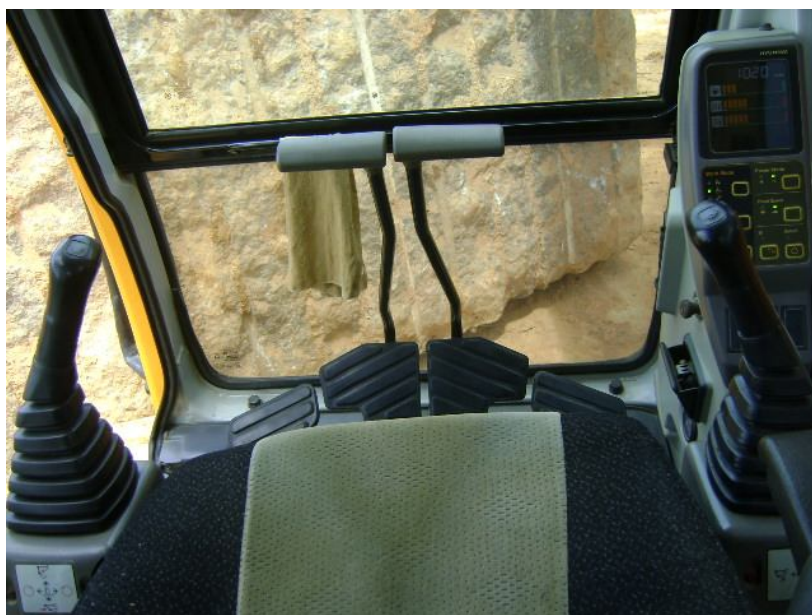
Figura 67 Painel de controle da retro-escavadeira e pedais de aceleração e freio do equipamento;
