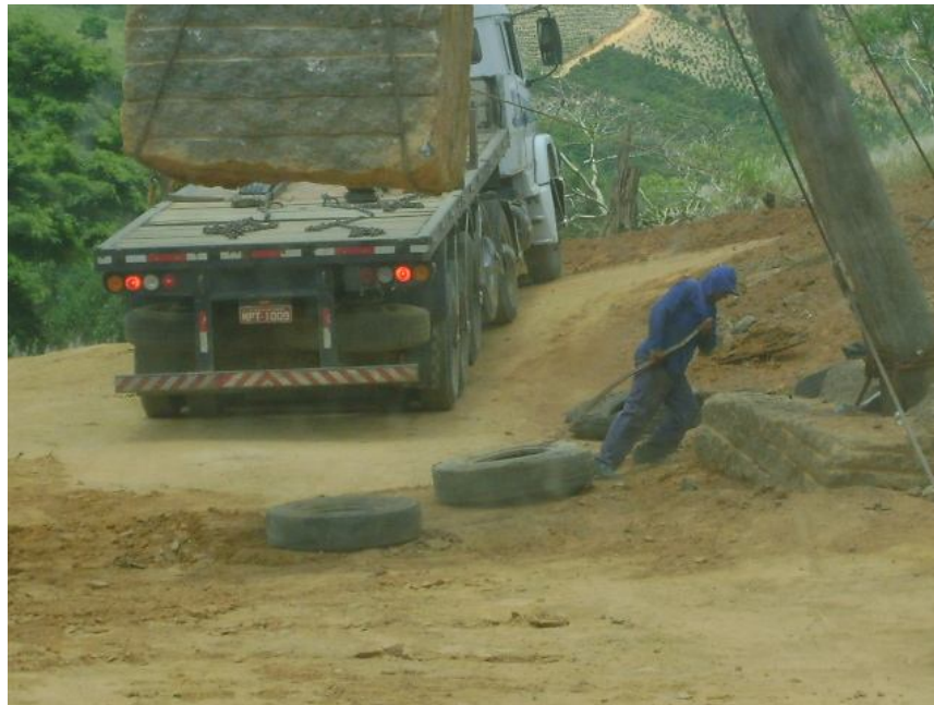
Figura 44 Com o bloco suspenso, o trabalhador retira os pneus para que a carreta possa estacionar na posição em que o bloco possa ser colocado na carroceria;
