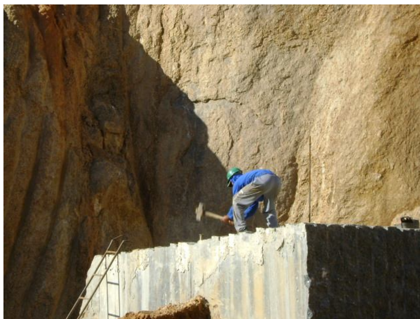
Figura 21 Utilização da cunha no processo de separação de blocos;
