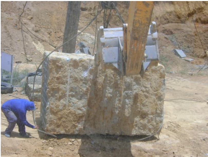
Figura 51 Ajudante auxiliando na preparação do bloco para carregamento da carreta;
