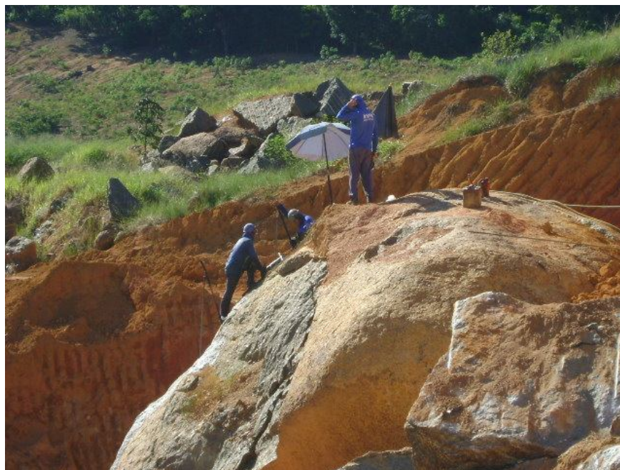
Figura 100 Trabalhadores efetuando a tarefa sem utilização da cerca de proteção contra quedas. (Foto tirada em janeiro de 2011);
