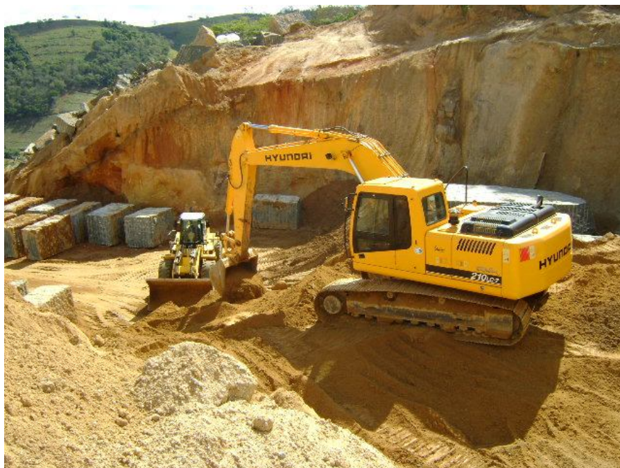
Figura 27 realizando a limpeza do pátio de divisão da lavra de matacão em pranchas e corte dos blocos;
