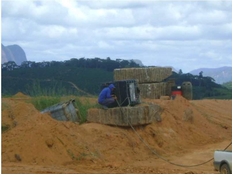
Figura 50 Transferência de combustível do galão de veículo da empresa para o galão armazenador da pedreira;
