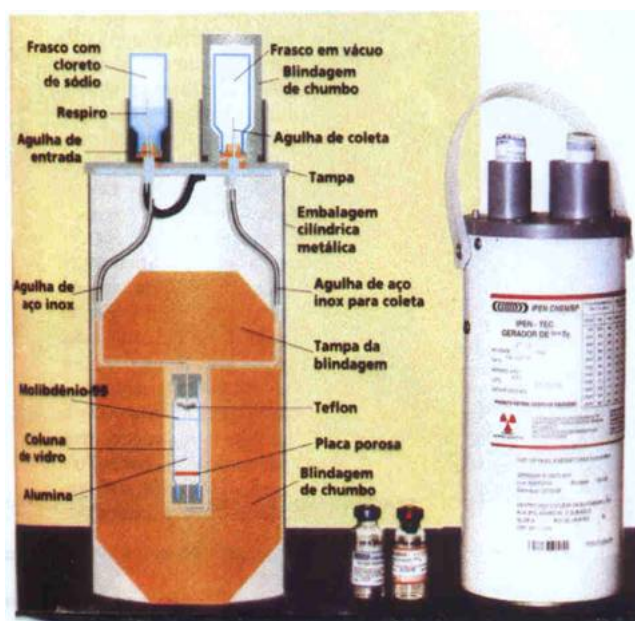
Figura 1. Gerador de ^{99}\text{Mo} / ^{99m}\text{Tc} . Fonte: IPEN – CNENSP
