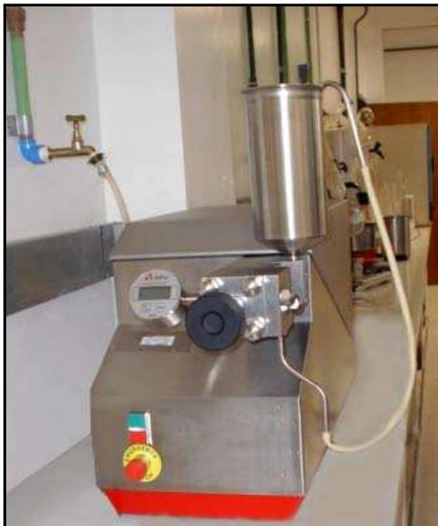
**Figura 12 - Homogeneizador de alta pressão de estágio único.**
