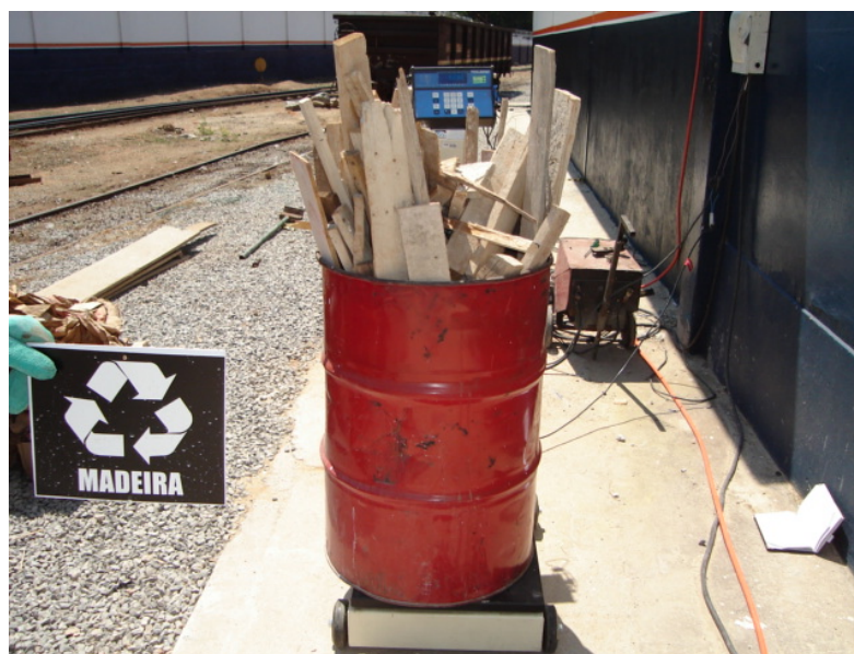
Figura 18 – Medição dos resíduos de madeira da obra industrial
