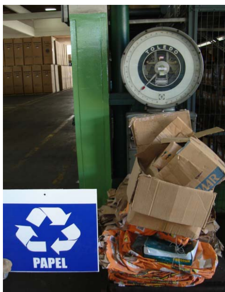
Figura 23 – Medição dos resíduos de papel / papelão da obra de reforma
