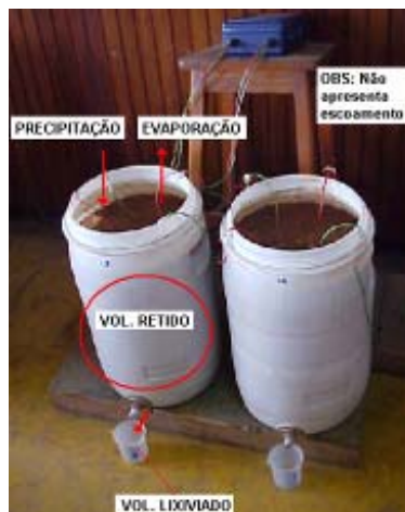
Figura 4.64 – Esquema básico do balanço hídrico nos lisímetros em laboratório.
