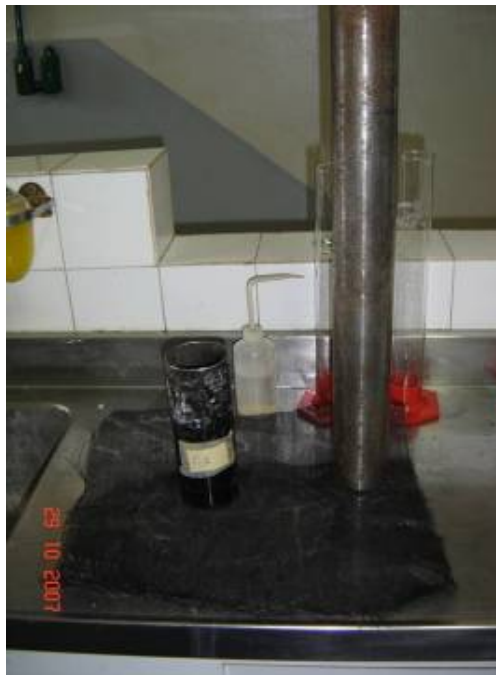
Figura 4.33 – Cilindro e soquete utilizados nos ensaios para determinação da composição volumétrica dos RSU
