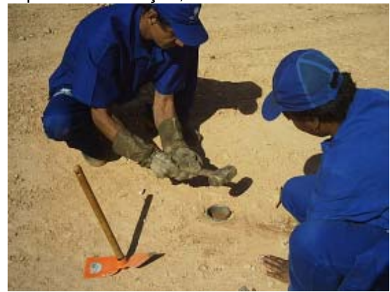
Figura 4.13 – Retirada de amostras para determinação do teor de umidade e peso específico, 2004
