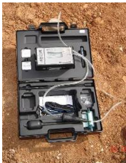
Figura 4.52 – Equipamento utilizado para realização das leituras de concentração de biogás
