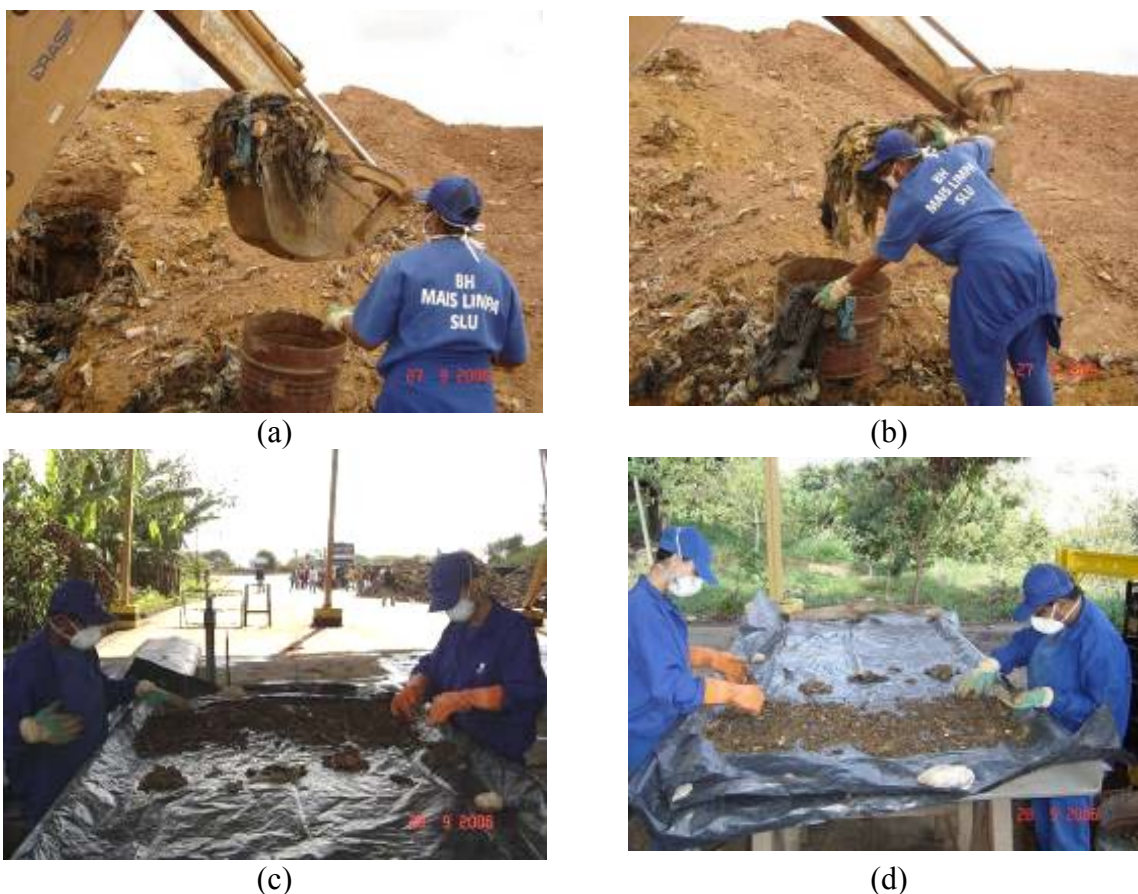
Figura 5.4 – Retirada de amostra e triagem de RSU do Aterro Sanitário Experimental.
