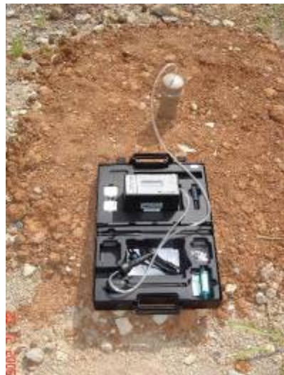
Figura 4.53 – Realização de leitura direta nos drenos de biogás
