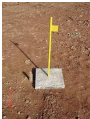
Figura 4.46 – Medidor de recalques
