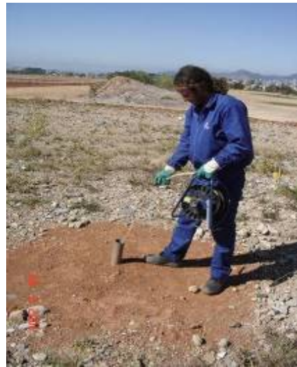
Figura 4.56 – Realização de leitura nos poços de monitoramento
