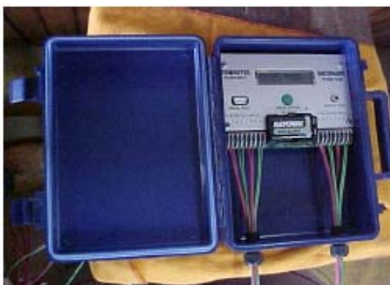
Figura 4.61 – Unidade de Leitura de Sucção e Temperatura WaterMark Monitor
