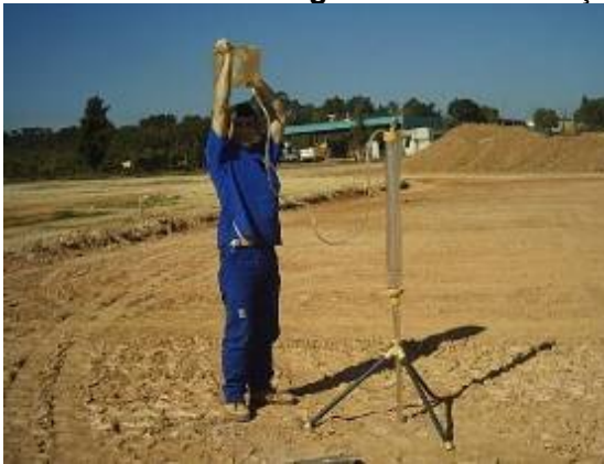
Figura 4.12 – Execução de ensaios de permeabilidade, 2004
