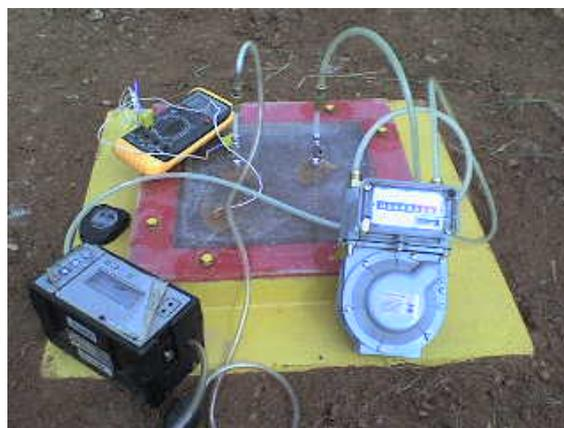
**Figura 4.18** – Ensaio da placa de fluxo utilizando o gasômetro.
