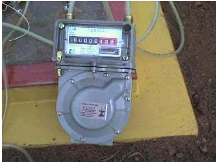
**Figura 4.12** – Medidor da vazão de gás.
