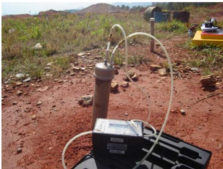
**Figura 4.23** – Ensaio realizado no dreno do Aterro Experimental utilizando metodologia semelhante à placa de fluxo.
