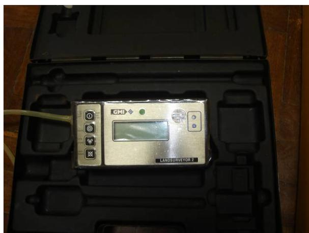
**Figura 4.10** – Aparelho de detecção de gases – Landsurveyor 2.
