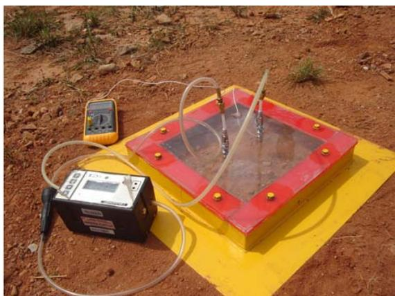
**Figura 4.17** – Ensaio utilizando a placa de fluxo.
