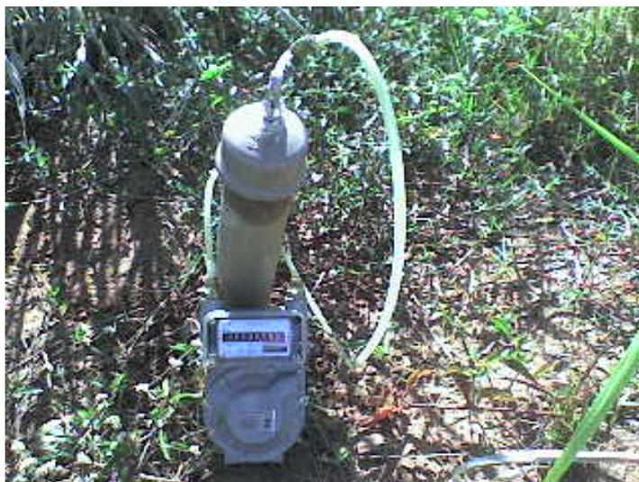
**Figura 4.24** – Medição de vazão no dreno do Aterro Experimental.
