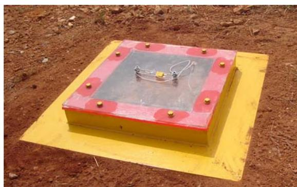
**Figura 4.16** – Placa de fluxo cravada no solo de cobertura.
