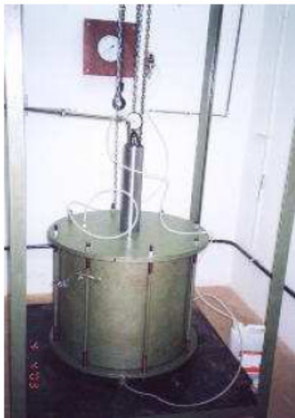
Figura 3.8 – Consolidômetro de grandes dimensões usado em ensaios de compressão confinada (Nascimento et. al. , 2007)
