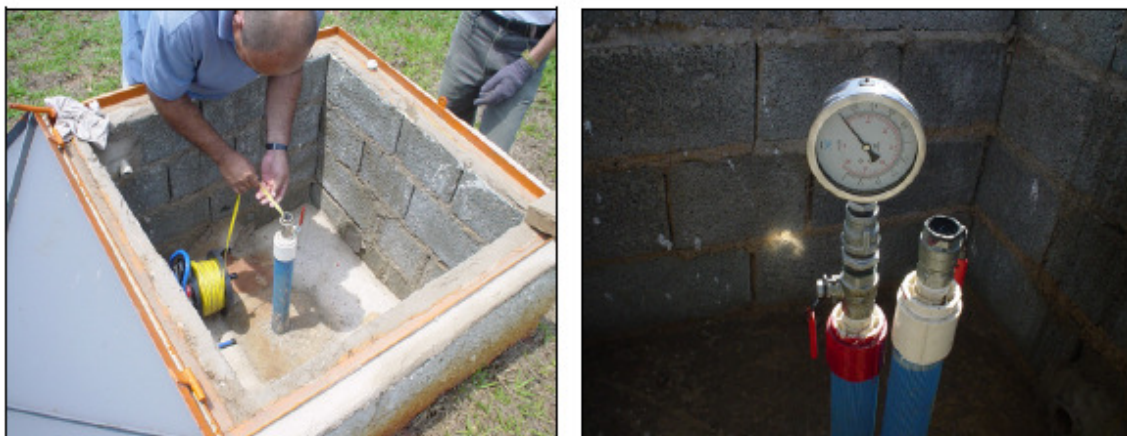
Figura 3.3 – Instrumentos de medição do nível de líquidos e gases (Jorge et al. , 2004)
