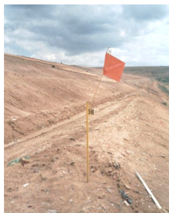
Figura 3.6 – Placa de recalque no aterro de Belo Horizonte
