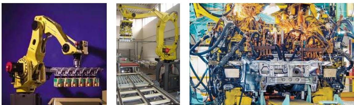
Figura 1.1: Exemplos de robôs industriais e suas aplicações, onde à esquerda tem-se um para a manipulação de pequenos objetos, ao centro outro para o transporte de grandes cargas e à direita um para a soldagem de carros.
