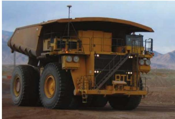
Figura 1.3: Caminhão fora de estrada autônomo produzido pela Komatsu para ambientes de mineração [Jamasmie, 2009].
