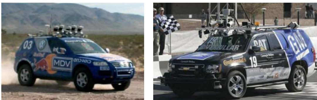
Figura 1.2: Carros autônomos campeões dos desafios DARPA ([DARPA, 2005] e [DARPA, 2008]). O veículo da esquerda é o Stanley [Thrun et al., 2006], campeão em 2005, e o da direita é o Boss [Urmson et al., 2008], campeão em 2007.
