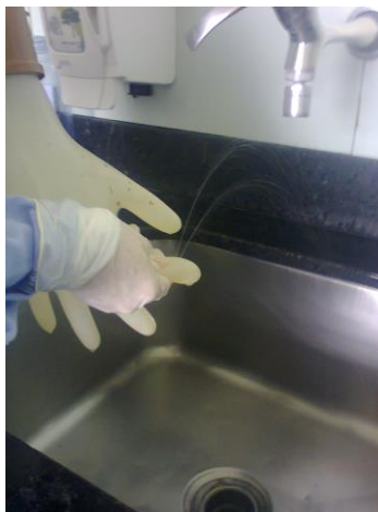
FIGURA 4 – Perfuração detectada pelo teste reproduzido conforme descrito pela Norma Europeia EN 455-1.
