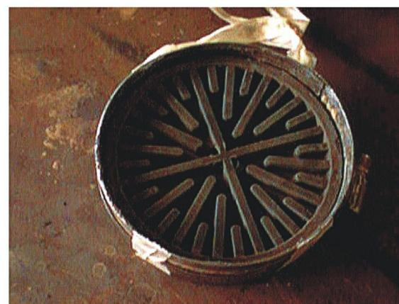
Figura 4.4 - Teste de Folha Montagem EIMCO
