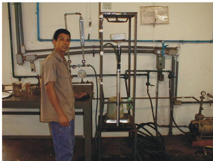
Figura 4.5 - Funil de Büchner: Montagem com Coluna de Filtrado ( alimentação por cima)
