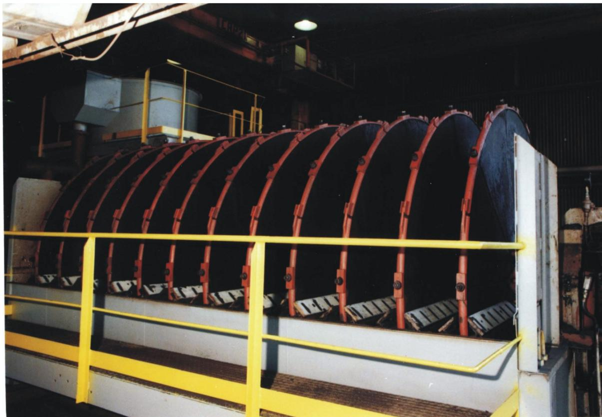
Figura 3.9- Filtro a vácuo de discos verticais: MBR/MAC
