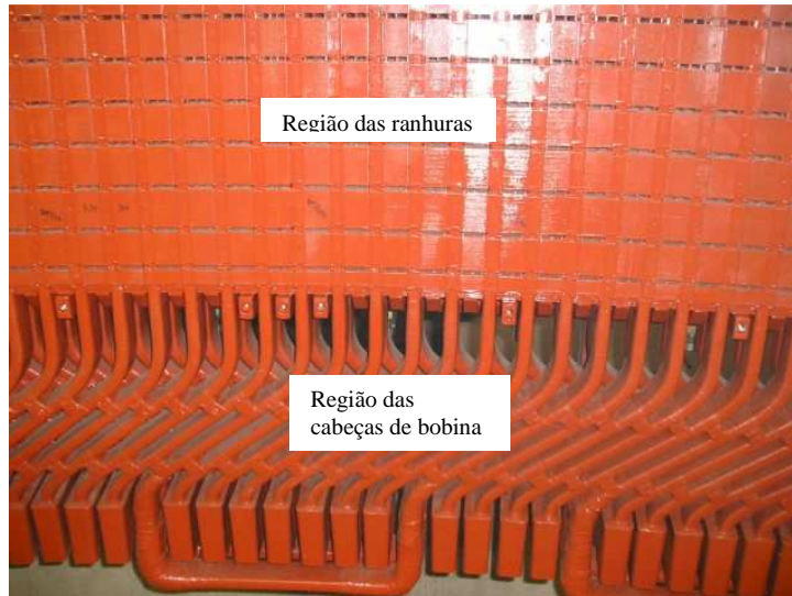
Figura 3.3 – Foto da vista interna do enrolamento do estator de um grande hidrogerador de 116 MVA e 14,4 kV, sem o rotor
