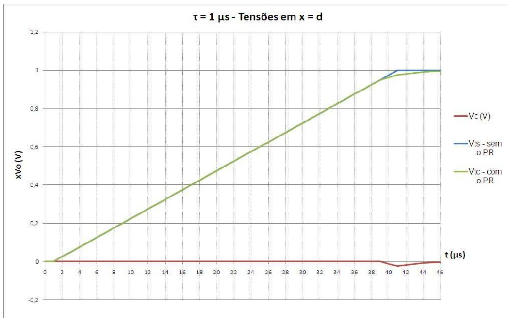
Figura A.6 – Formas de onda das tensões em x = d , para \tau_1 = 1 \mu s
