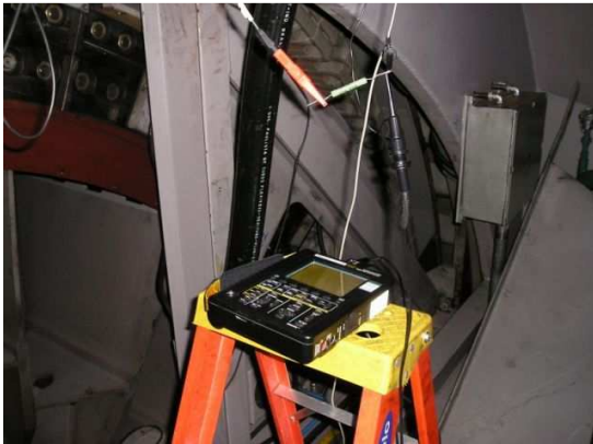
Figura 4.19 – Medição da tensão V1 no terminal de fase da máquina, com um resistor de 45 \Omega em série com o enrolamento, Caso B
