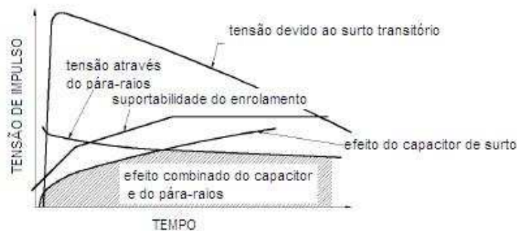
Figura 2.15 – Exemplo de proteção com os efeitos combinados do capacitor e do pára-raios, adaptado de [24]
