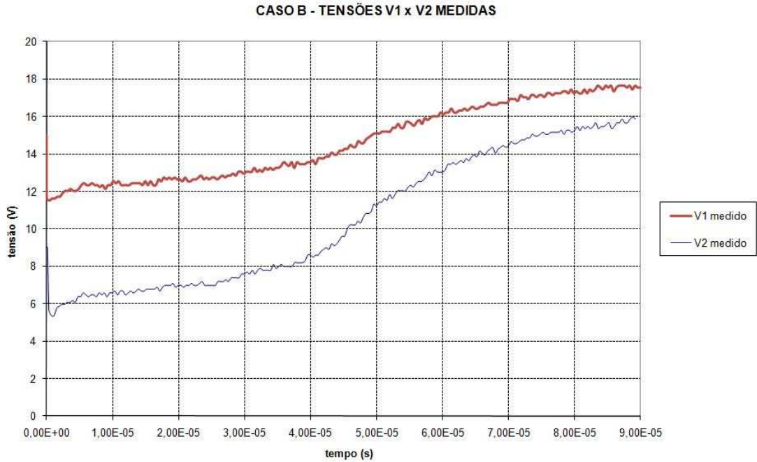
Figura 4.27 – Tensões medidas V1 e V2 em uma fase do gerador para o Caso B
