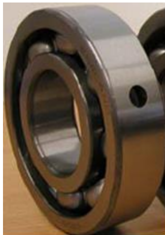
Figura 2.16: Rolamento com furo radial de 8 mm no anel externo.
