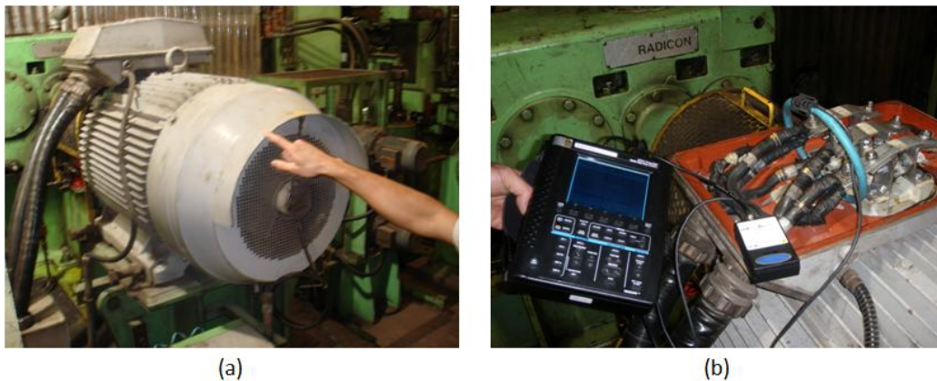
Figura 2.21: Preparação para coleta de dados das grandezas de modo comum do sistema real. (a) Motor em análise. (b) Sensor de corrente envolvendo as três fases simultaneamente.
